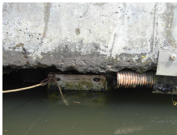
Nettoyage des sondes de vitesses à partir d'une embarcation légère
