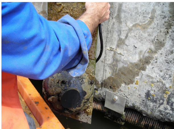
Nettoyage des sondes de vitesses à partir d'une embarcation légère
