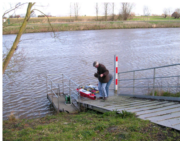
Nettoyage des sondes de vitesses à partir d'une embarcation légère
