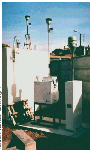
Station de mesures, préleveurs de métaux et d'hydrocarbures aromatiques polycycliques (HAP).
