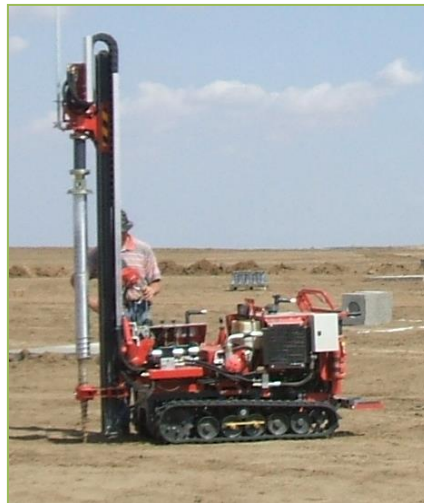
Photographie 14 - Engin utilisé pour l'ancrage des panneaux solaires photovoltaïques
