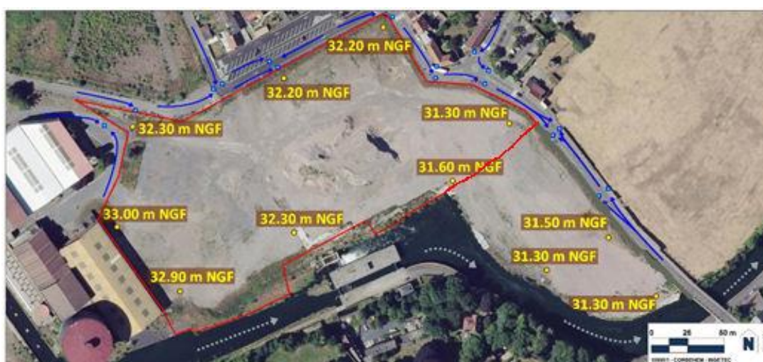
Schéma 2 : Fonctionnement hydraulique en périphérie de plateforme et points topo
