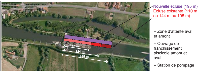
Figure 4 : Projet pour l'écluse de Quesnoy-sur-Deûle (source : CSC)
