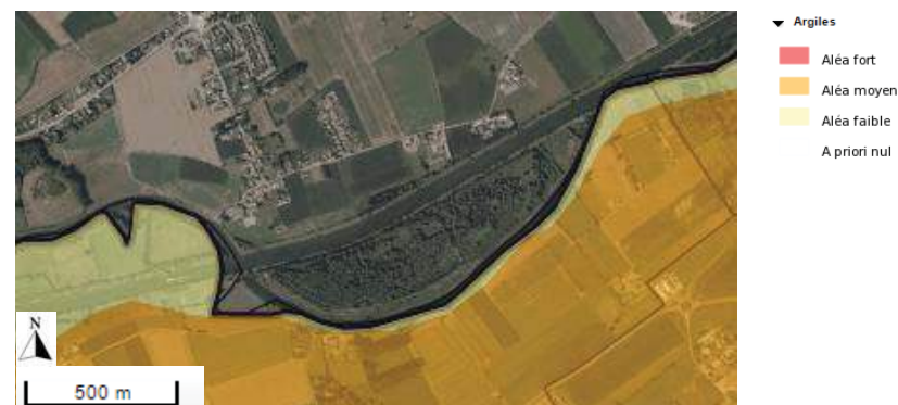
Figure 11 : Cartographie du risque de gonflement/retrait des argiles au niveau du délaissé de Warneton
