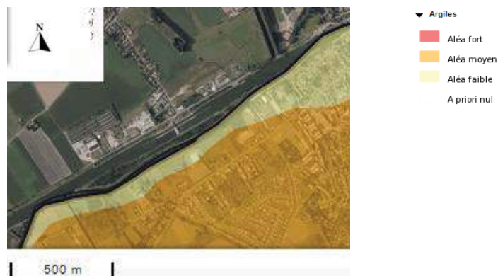
Figure 31 : Cartographie du risque de gonflement/retrait des argiles au niveau du délaissé de Comines
