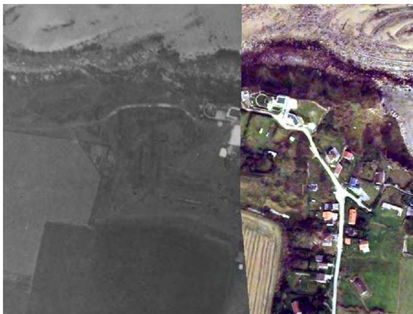
Figure 4-1 : exemple de défaut de projection des photos aériennes 1930
