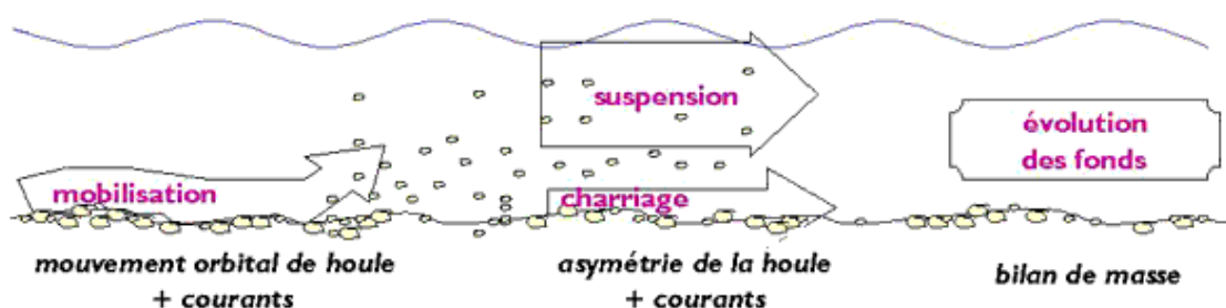
Figure 3-6 : Schéma de principe du transport des sables et des graviers (source : www.ifremer.fr )
