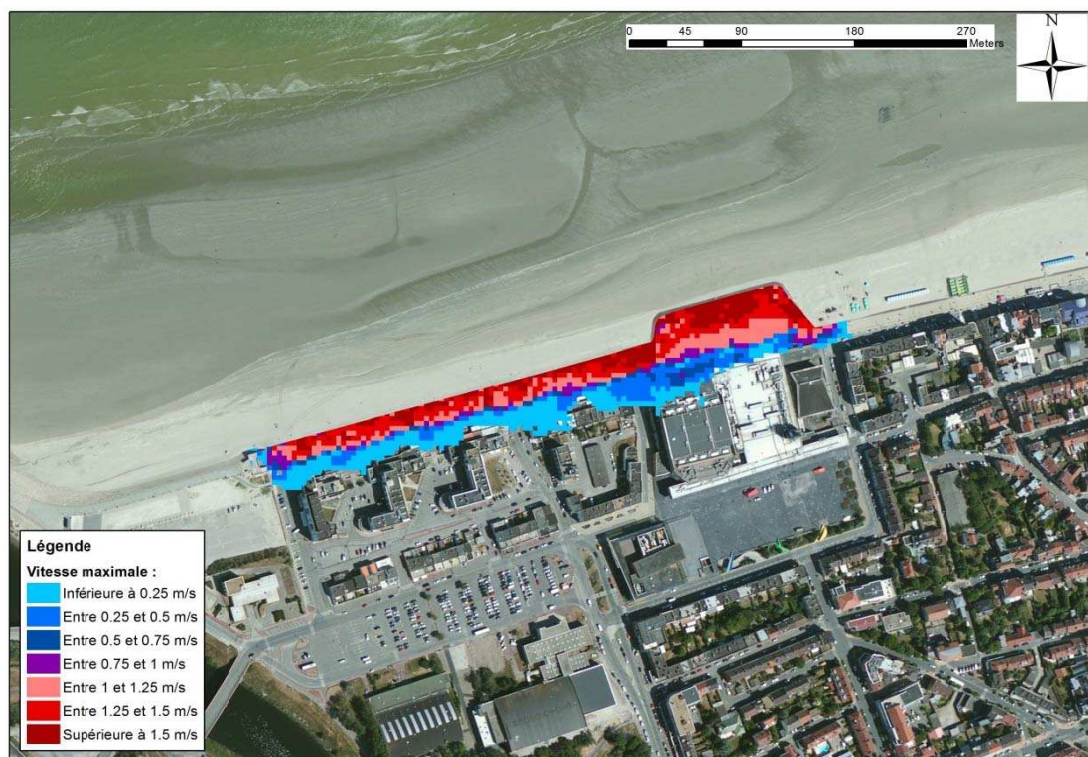
Figure 8-39 : Malo les Bains - Cartographie de la vitesse de submersion modélisée pour un événement décennal
