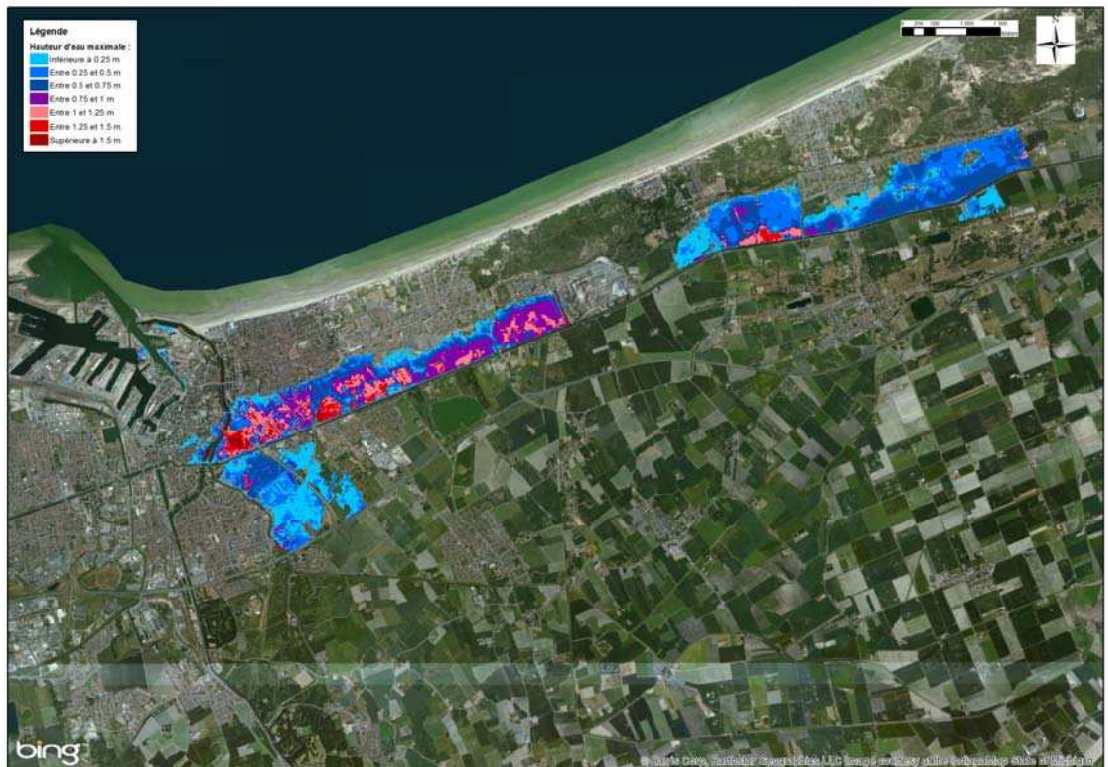
Figure 8-82 : Dunkerque - Cartographie de la hauteur de submersion modélisée pour un événement centennal
