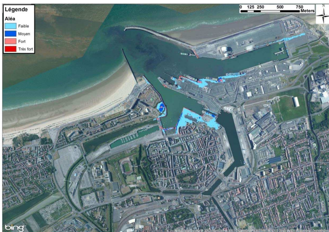
Figure 8-145 : Calais – Cartographie de l'aléa submersion modélisé pour un événement centennal à l'horizon 2100
