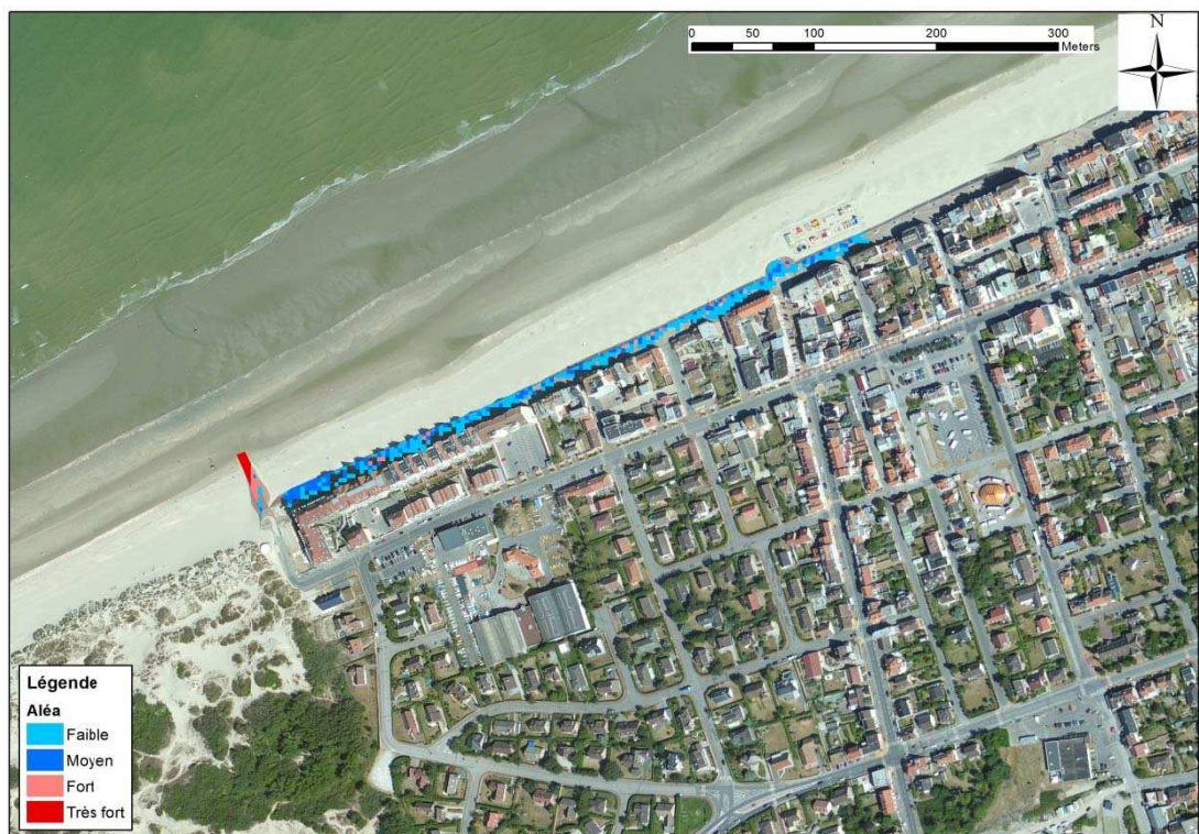
Figure 8-18 : Bray-Dunes - Cartographie de l'aléa submersion modélisé pour un événement décennal
