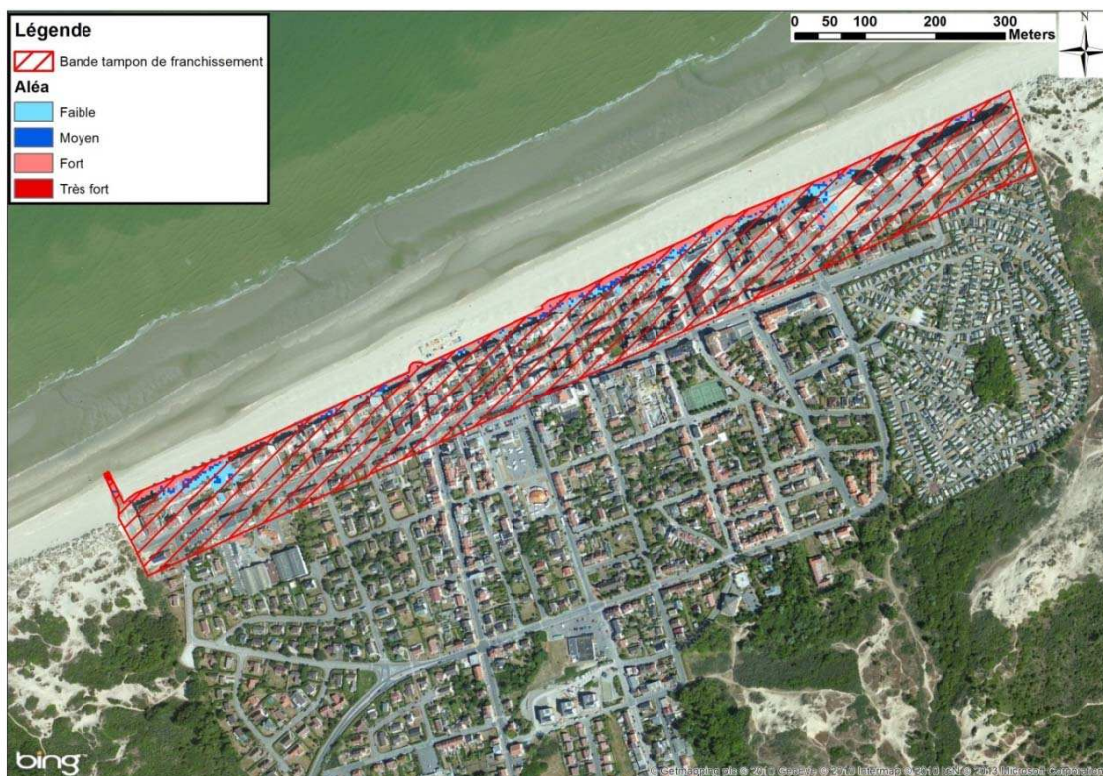
Figure 8-21 : Bray-Dunes - Cartographie de l'aléa submersion modélisé pour un événement centennal
