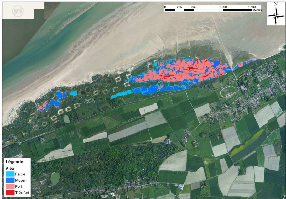
Figure 8-122 : Marck - Cartographie de l'aléa submersion modélisé pour un événement décennal
