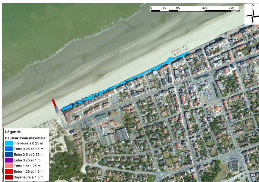
Figure 8-16 : Bray-Dunes - Cartographie de la hauteur de submersion modélisée pour un événement décennal
