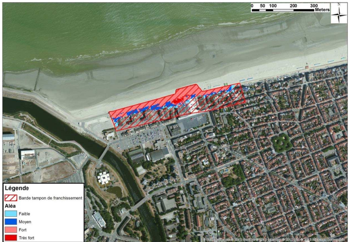
Figure 8-43 : Malo les Bains - Cartographie de l'aléa submersion modélisé pour un événement centennal
