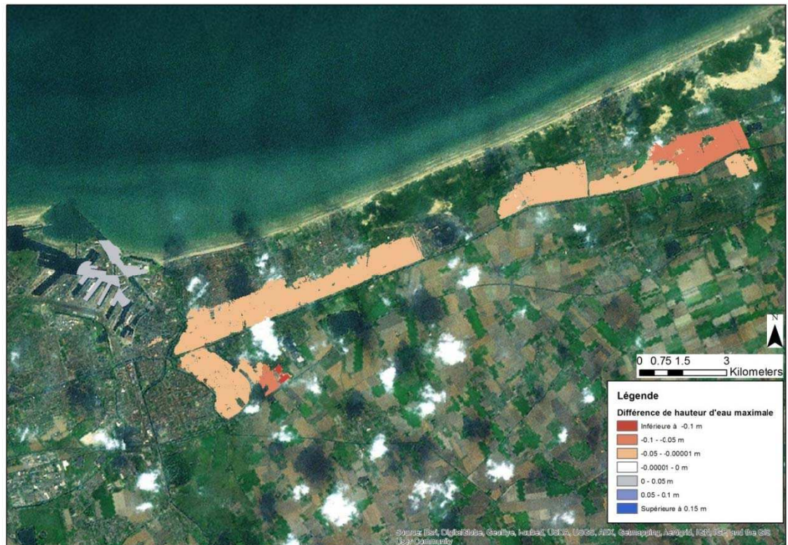
Figure 8-58 : Carte différentielle de hauteur d'eau maximale entre la simulation avec ouvrage de Tixier fermé et celle avec ouvrage de Tixier ouvert à marée descendante pour l'événement centennal
