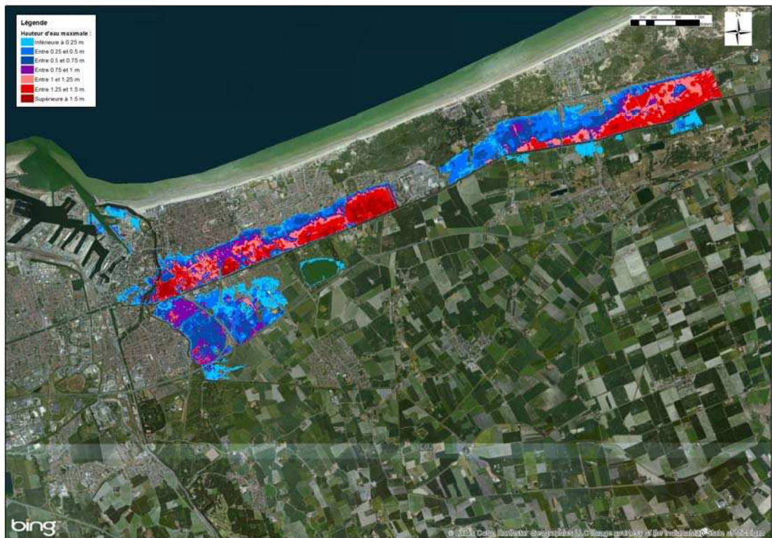
Figure 8-85 : Dunkerque - Cartographie de la hauteur de submersion modélisée pour un événement centennal à l'horizon 2100
