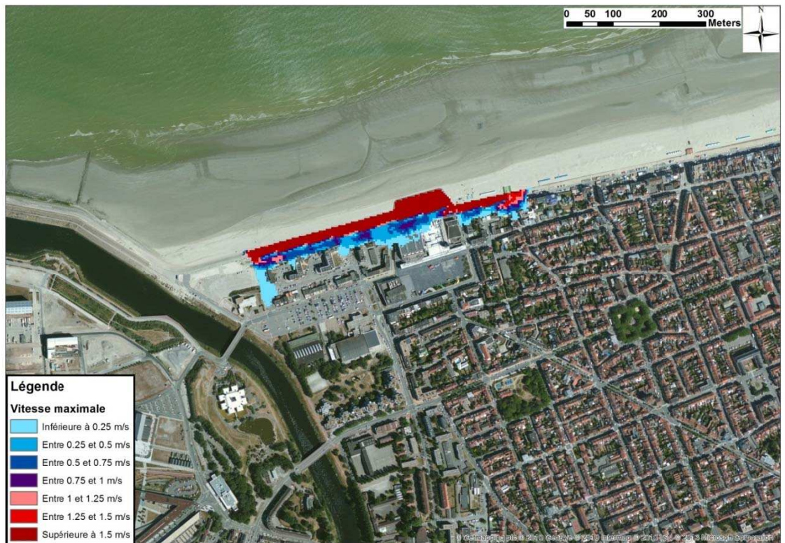
Figure 8-45 : Malo les Bains - Cartographie de la vitesse d'écoulement modélisée pour un événement centennal à l'horizon 2100
