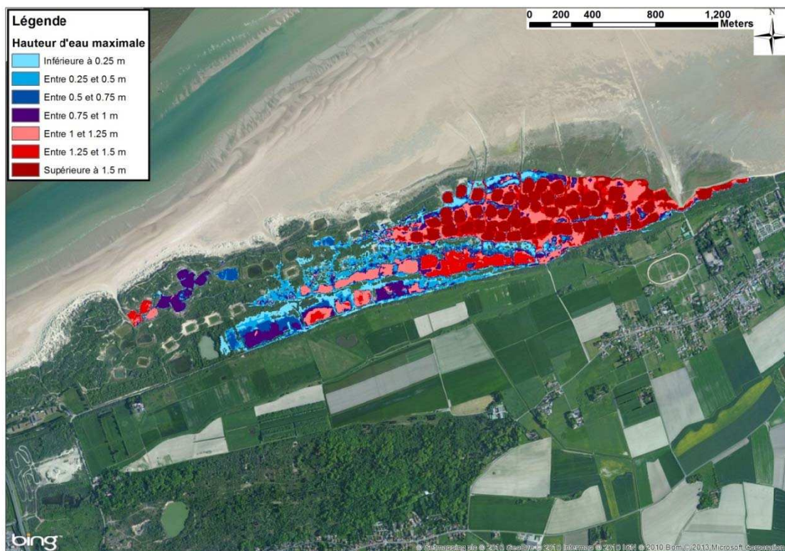
Figure 8-126 : Marck - Cartographie de la hauteur de submersion modélisée pour un événement centennal à l'horizon 2100
