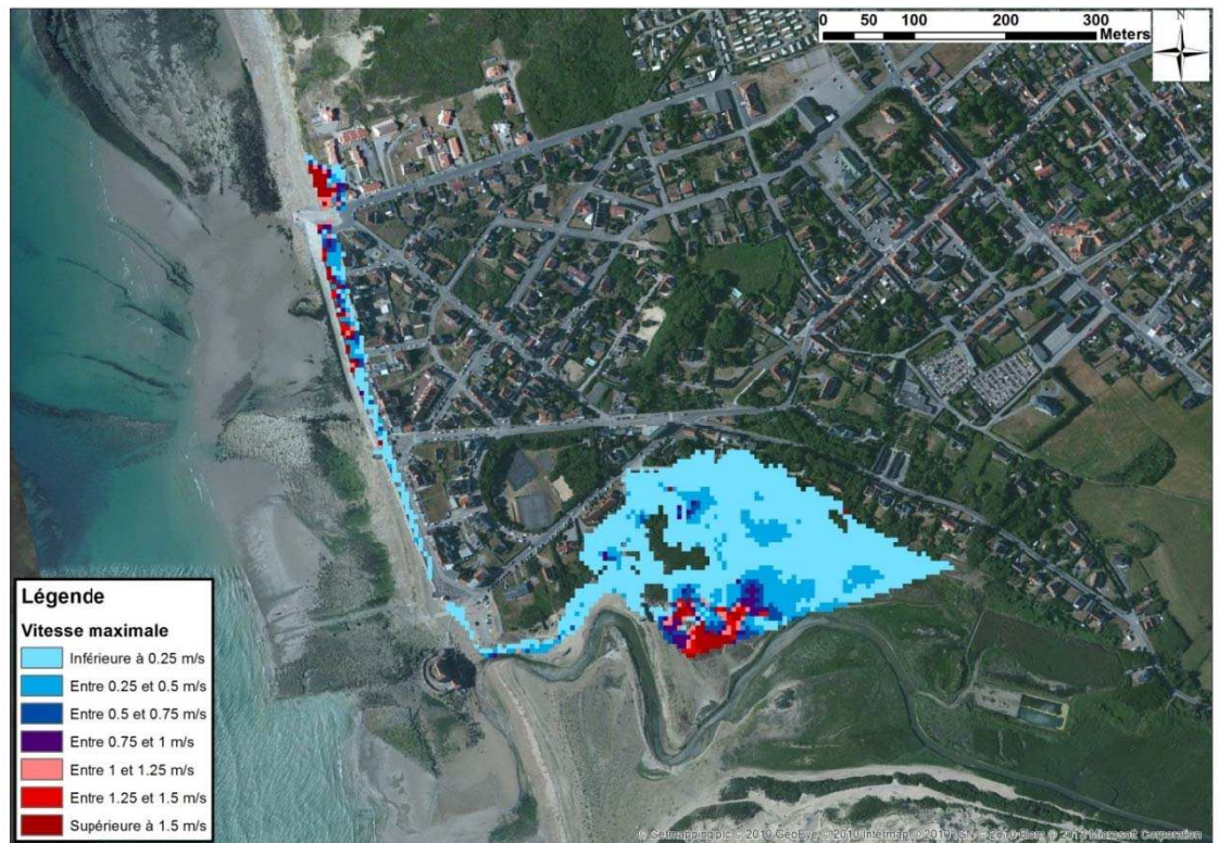
Figure 8-274 : Ambleuse - Cartographie de la vitesse d'écoulement modélisée pour un événement centennal à l'horizon 2100
