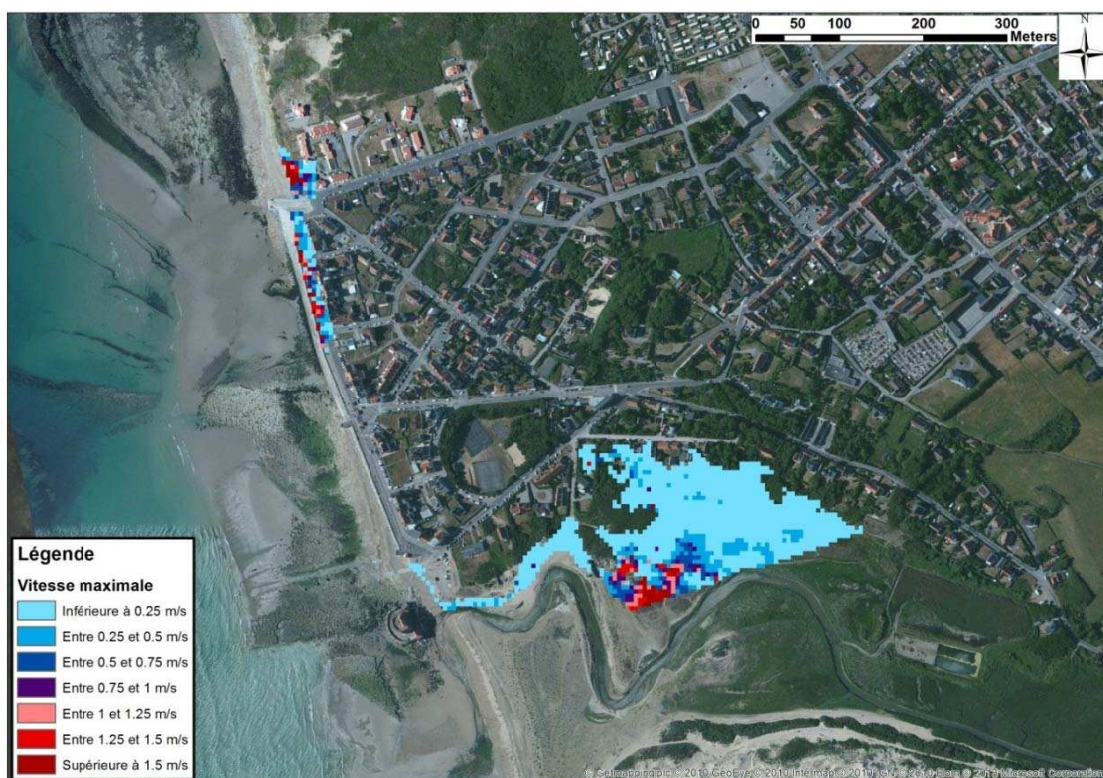
Figure 8-271 : Ambleteuse - Cartographie de la vitesse d'écoulement modélisée pour un événement centennal
