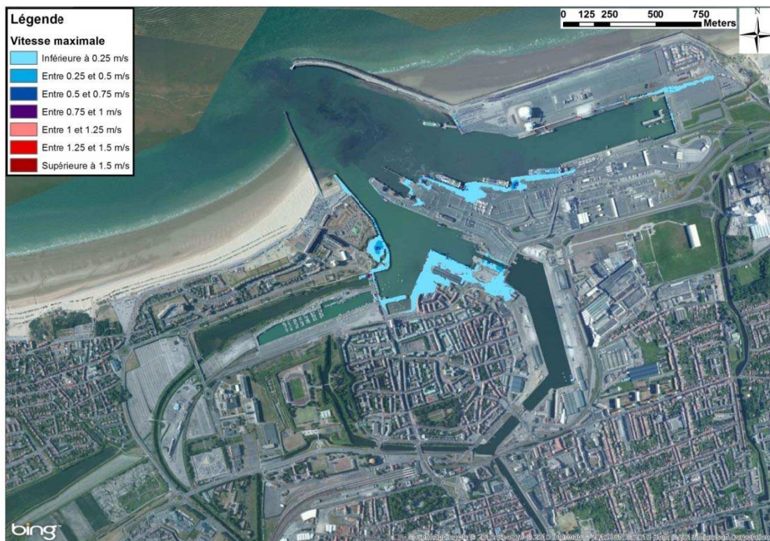
Figure 8-144 : Calais - Cartographie de la vitesse d'écoulement modélisée pour un événement centennal à l'horizon 2100
