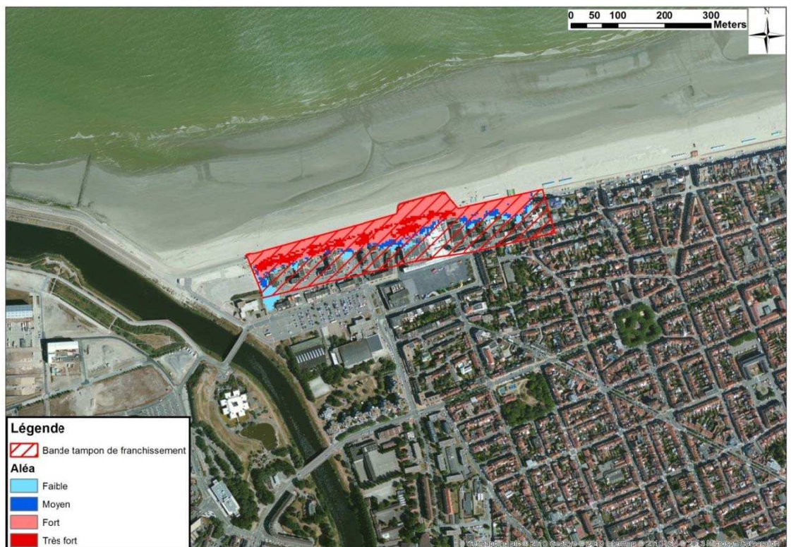
Figure 8-46 : Malo les Bains - Cartographie de l'aléa submersion modélisé pour un événement centennal à l'horizon 2100
