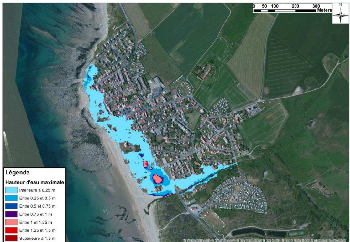
Figure 8-249 : Audresselles - Cartographie de la hauteur de submersion modélisée pour un événement centennal à l'horizon 2100
