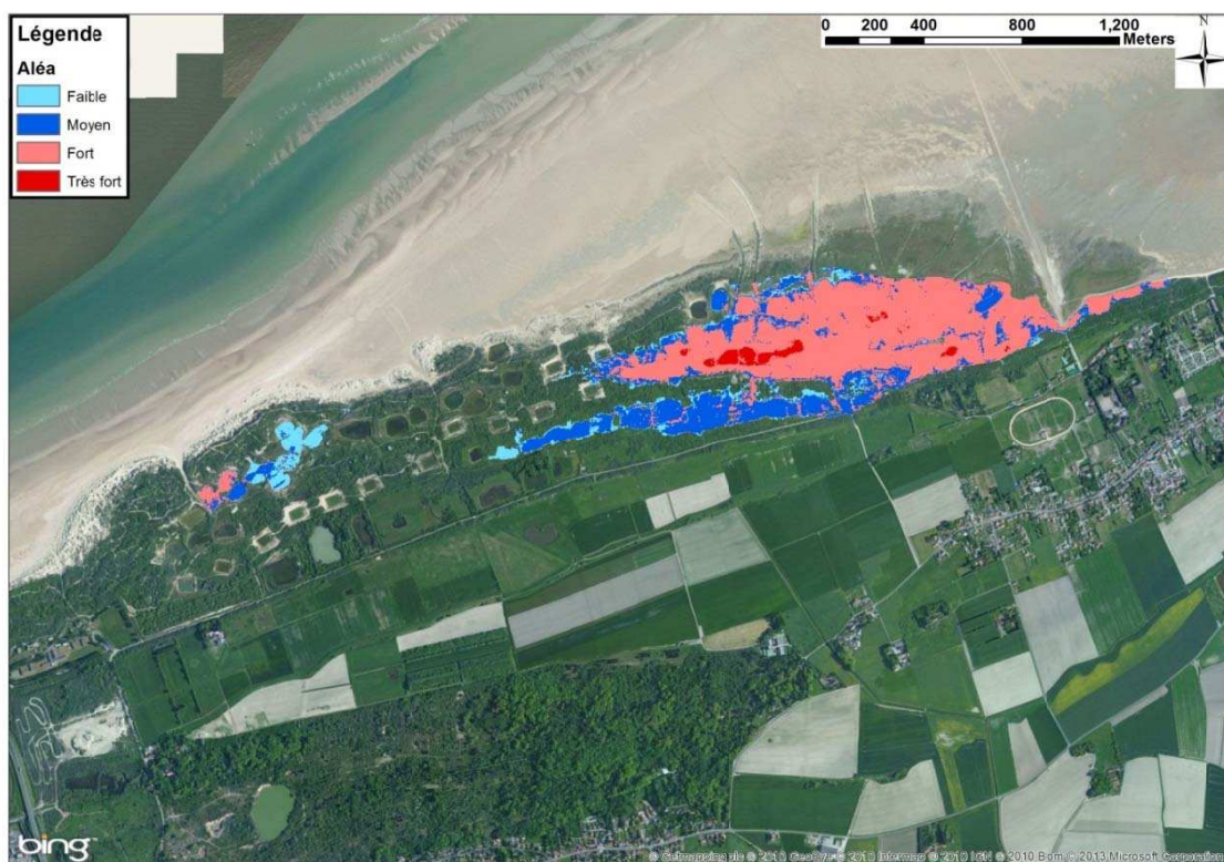
Figure 8-125 : Marck - Cartographie de l'aléa submersion modélisé pour un événement centennal
