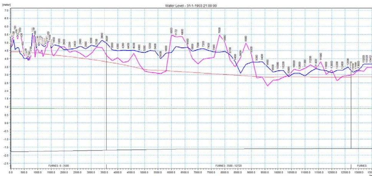
Figure 8-73 : Profil en long du canal de Furnes pour l'aléa T100 – en rouge ligne d'eau maximum, en rose berges RG, en bleu berges RD, en vert condition initiale.
