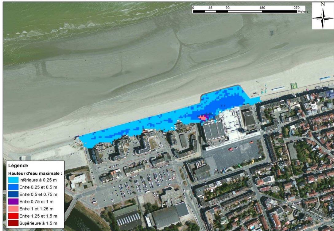
Figure 8-38 : Malo les Bains - Cartographie de la hauteur de submersion modélisée pour un événement décennal
