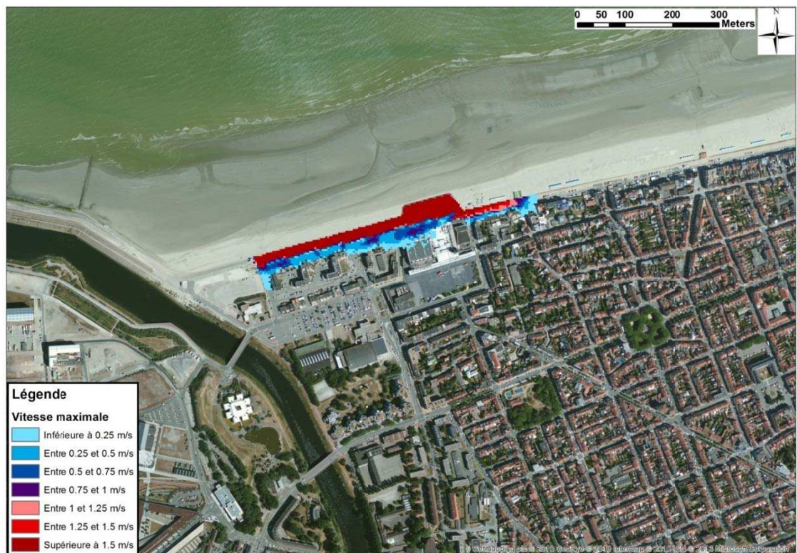
Figure 8-42 : Malo les Bains - Cartographie de la vitesse d'écoulement modélisée pour un événement centennal
