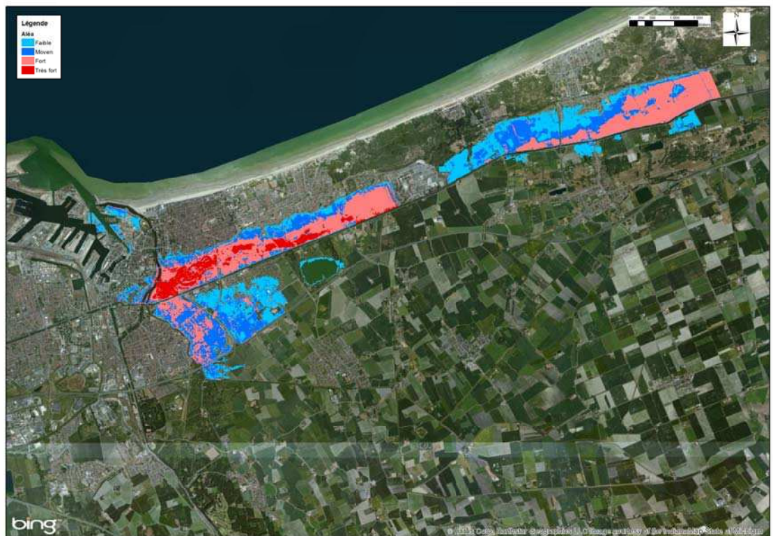
Figure 8-87 : Dunkerque - Cartographie de l'aléa submersion modélisé pour un événement centennal à l'horizon 2100
