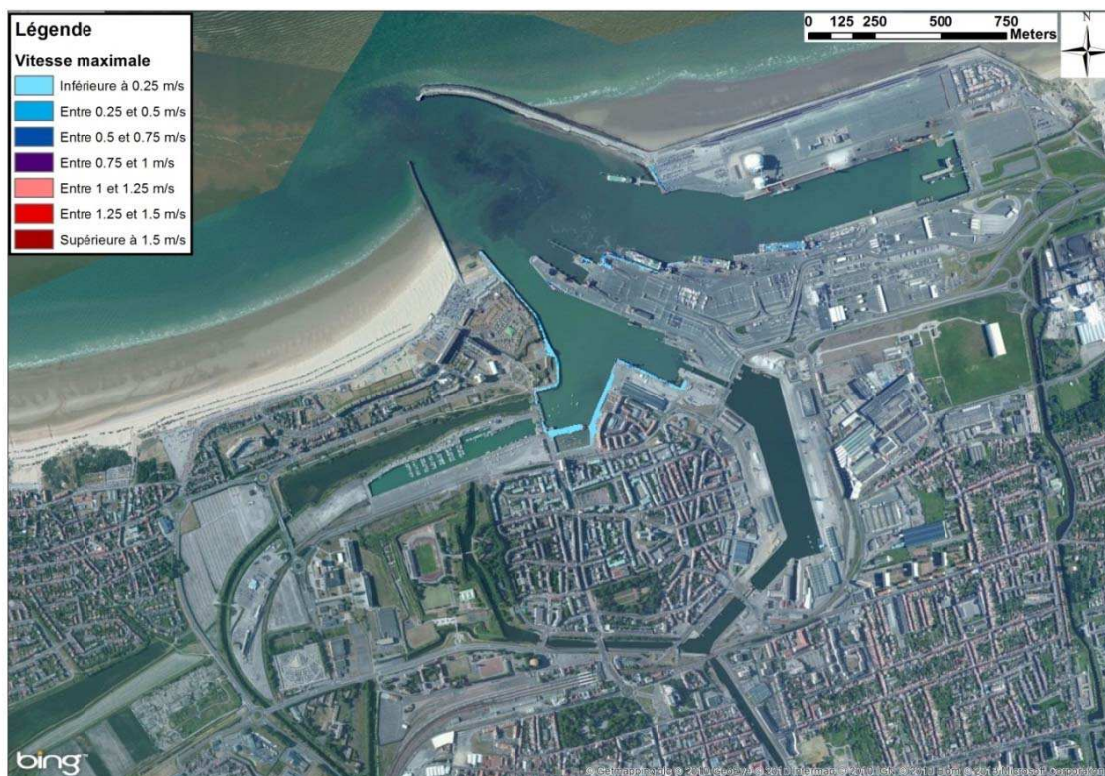
Figure 8-138 : Calais - Cartographie de la vitesse d'écoulement modélisée pour un événement centennial
