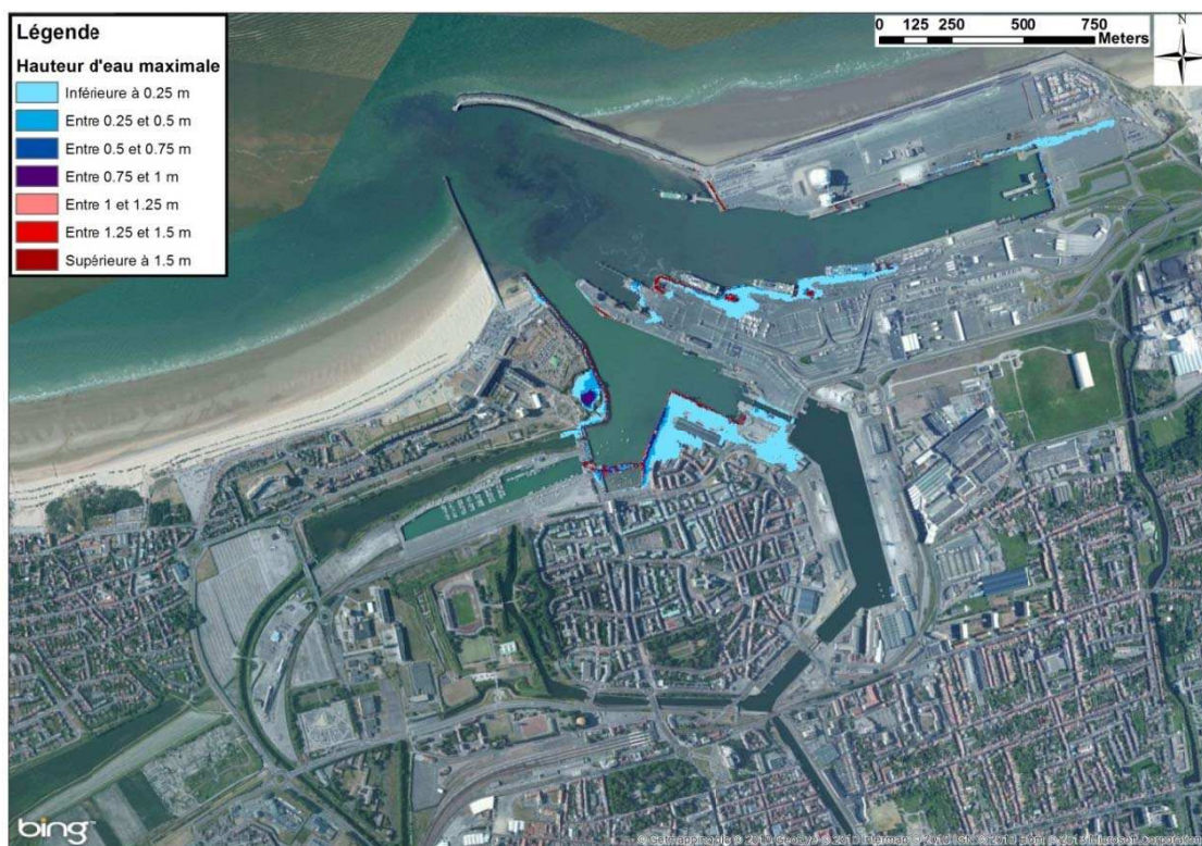
Figure 8-143 : Calais - Cartographie de la hauteur de submersion modélisée pour un événement centennal à l'horizon 2100
