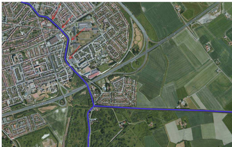
Figure 8-76 : Schéma explicatif de la restitution d'eau dans le canal des Moeres entraînant une modification du débit dans le canal de Coudekerque (affluent du canal des Moeres, au Sud)
