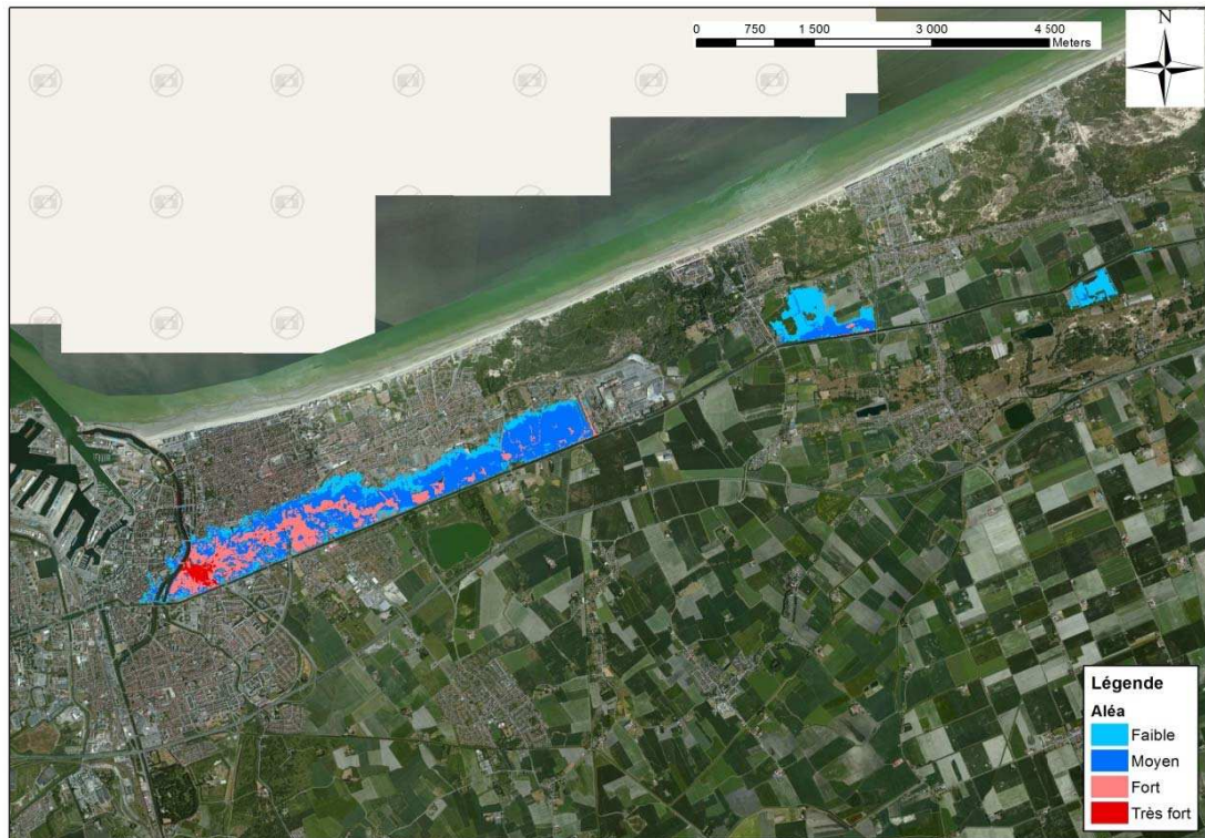
Figure 8-81 : Dunkerque - Cartographie de l'aléa submersion modélisé pour un événement décennal
