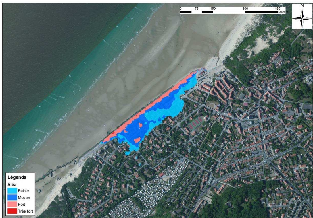
Figure 8-205 : Wissant - Cartographie de l'aléa submersion modélisé pour un événement décennal
