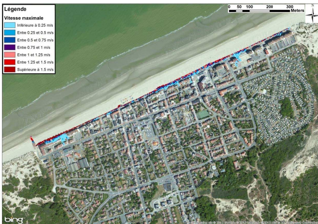
Figure 8-20 : Bray-Dunes - Cartographie de la vitesse d'écoulement modélisée pour un événement centennal
