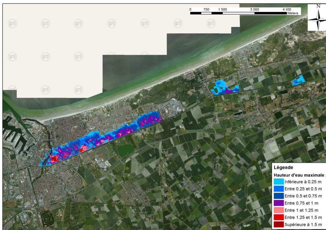
Figure 8-79 : Dunkerque –Cartographie de la hauteur de submersion modélisée pour un événement décennal
