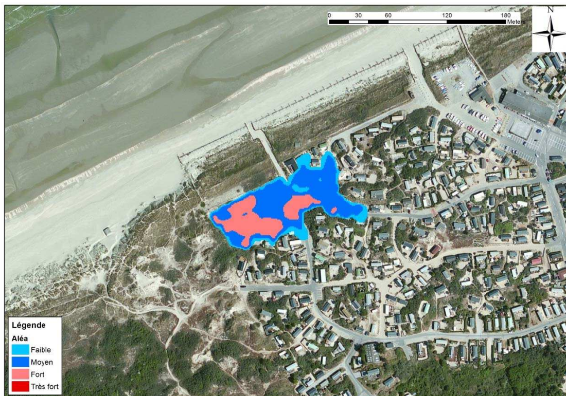
Figure 8-6 : Bray-Dunes, rupture cordon dunaire - Cartographie de l'aléa submersion modélisé pour un événement centennal
