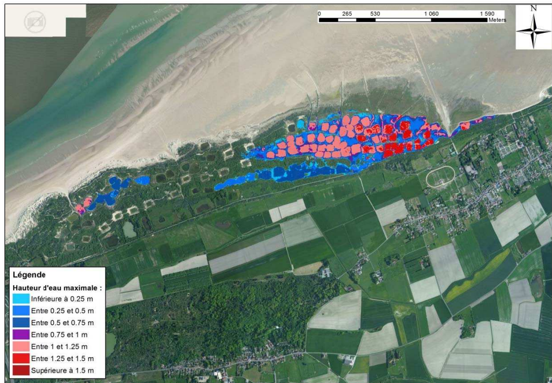
Figure 8-120 : Marck - Cartographie de la hauteur de submersion modélisée pour un événement décennal
