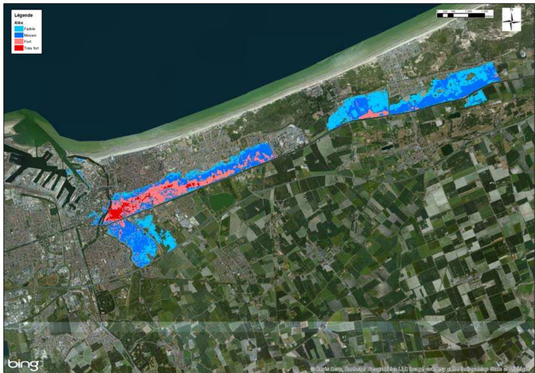
Figure 8-84 : Dunkerque - Cartographie de l'aléa submersion modélisé pour un événement centennal
