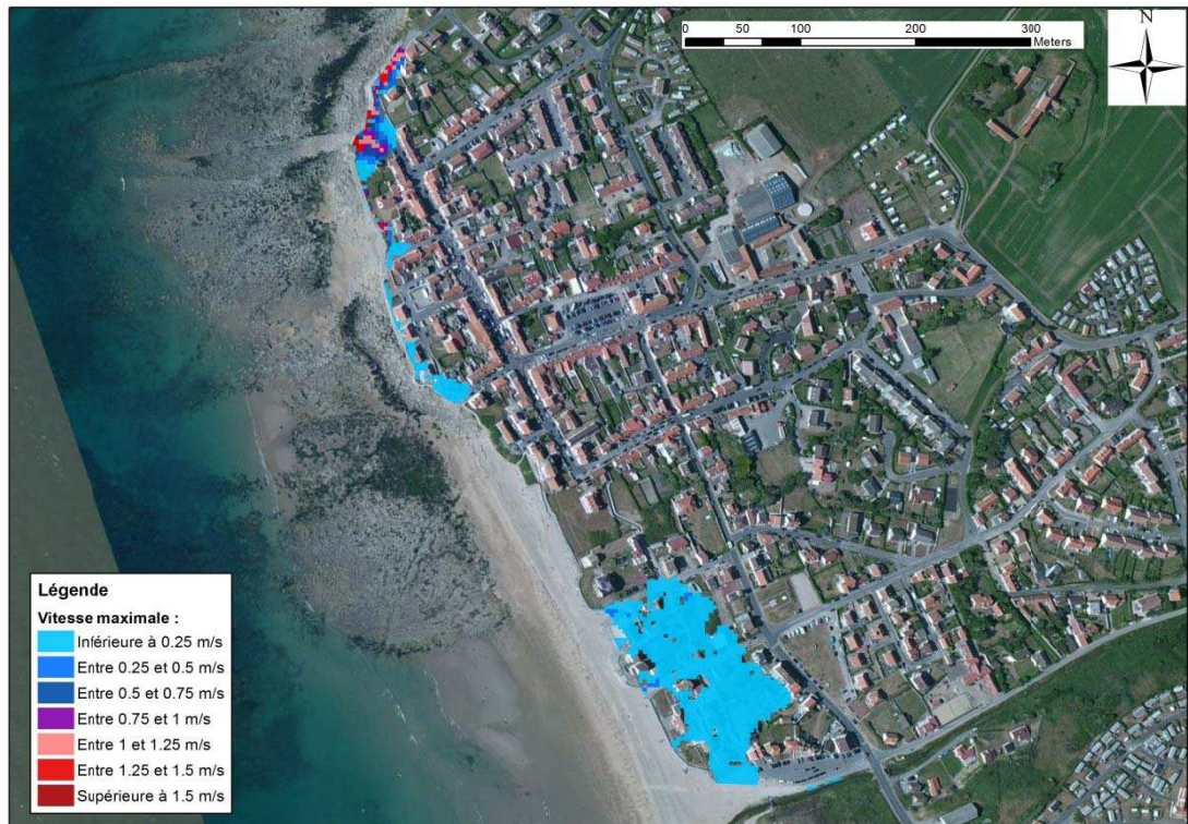
Figure 8-244 : Audresselles - Cartographie de la vitesse de submersion modélisée pour un événement décennal
