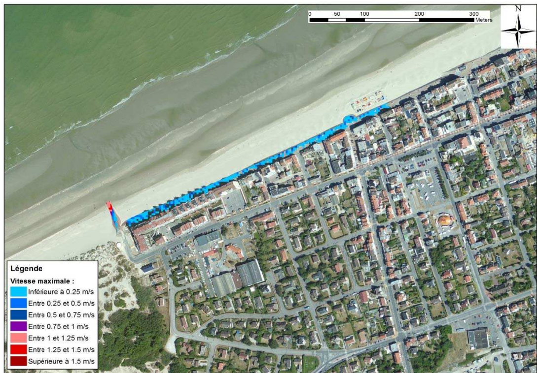
Figure 8-17 : Bray-Dunes - Cartographie de la vitesse d'écoulement modélisée pour un événement décennal
