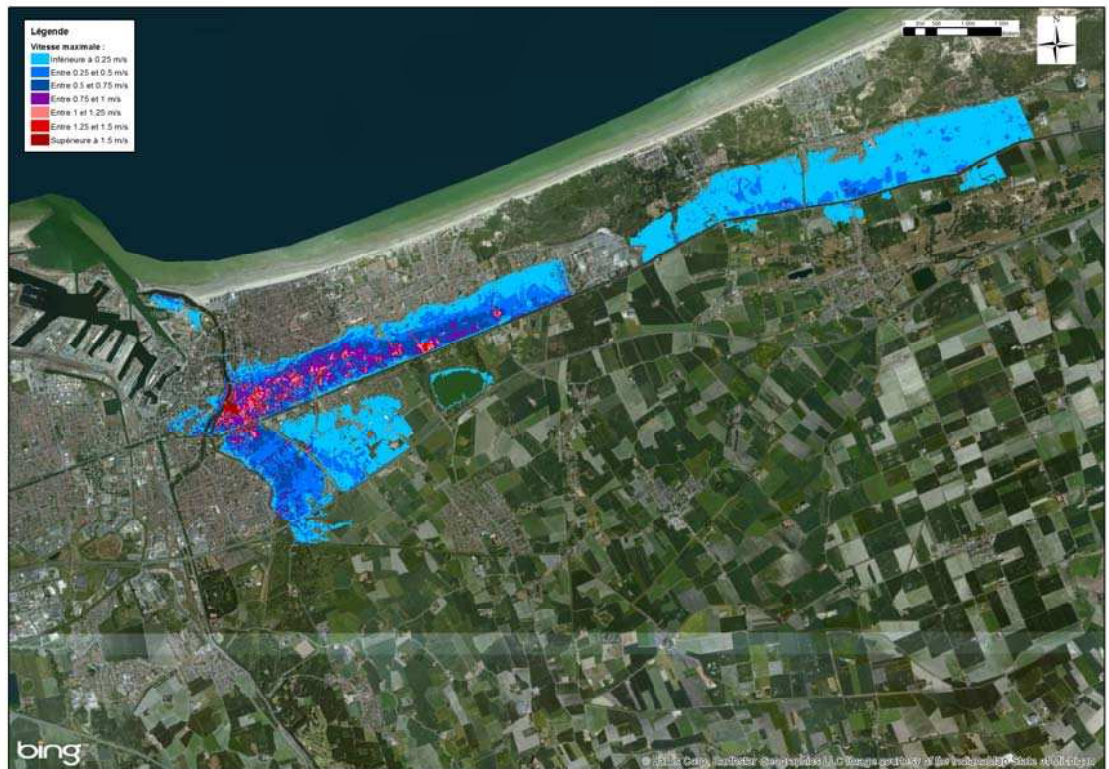
Figure 8-86 : Dunkerque - Cartographie de la vitesse d'écoulement modélisée pour un événement centennal à l'horizon 2100
