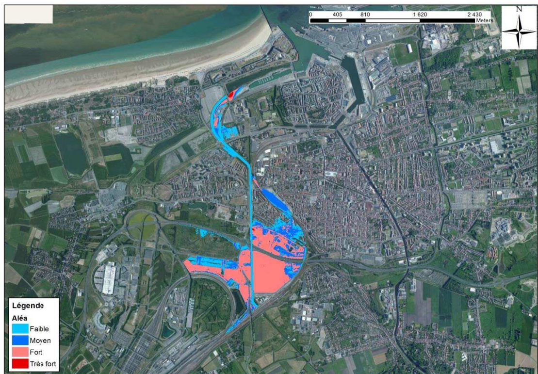
Figure 8-136 : Calais - Cartographie de l'aléa submersion modélisé pour un événement décennal
