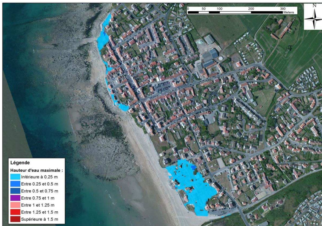
Figure 8-243 : Audresselles - Cartographie de la hauteur de submersion modélisée pour un événement décennal
