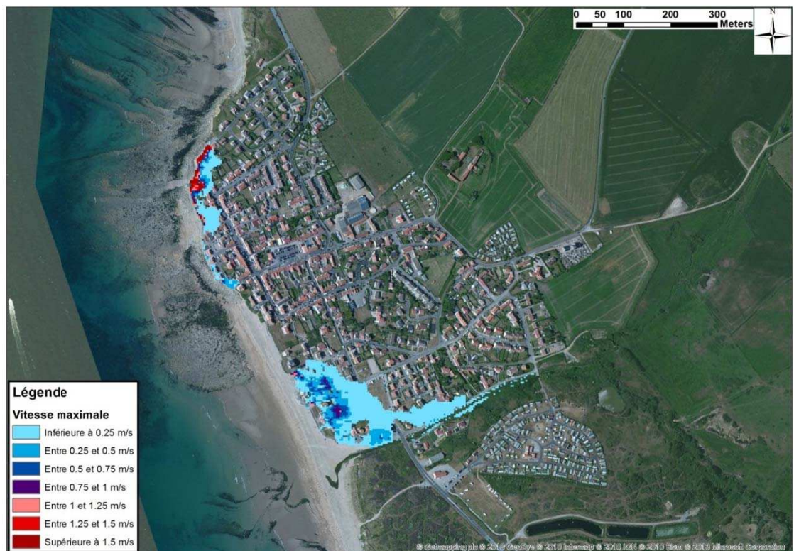
Figure 8-247 : Audresselles - Cartographie de la vitesse d'écoulement modélisée pour un événement centennal
