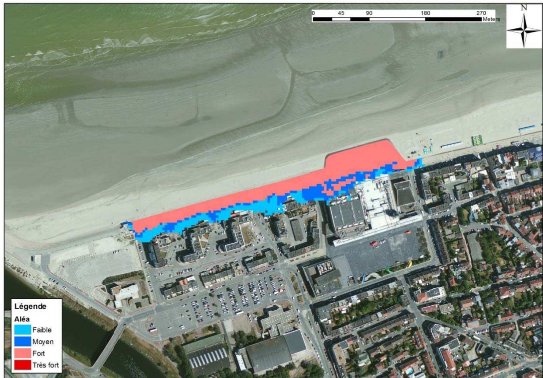
Figure 8-40 : Malo les Bains - Cartographie de l'aléa submersion modélisé pour un événement décennal
