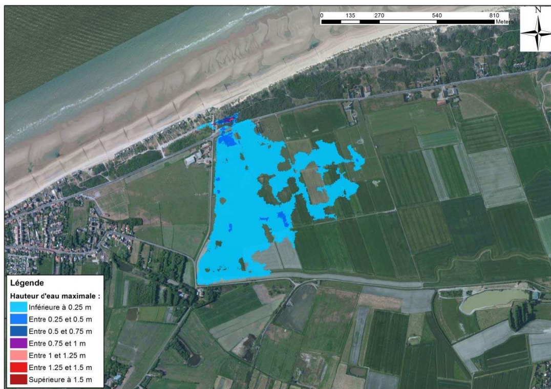
Figure 8-175 : Sangatte - Cartographie de la hauteur de submersion modélisée pour un événement décennal
