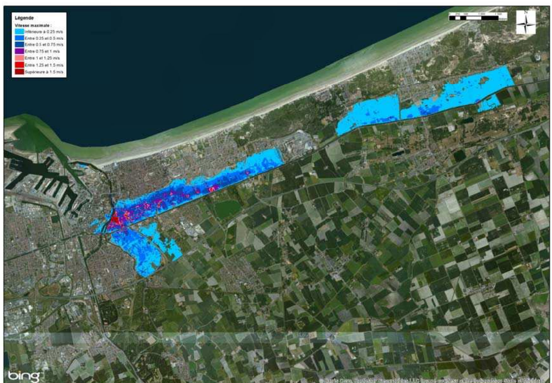
Figure 8-83 : Dunkerque – Cartographie de la vitesse d'écoulement modélisée pour un événement centennal
