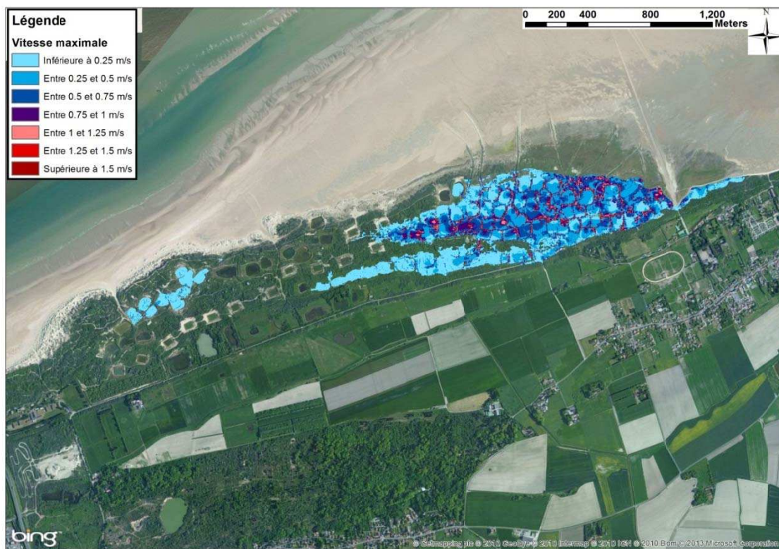
Figure 8-124 : Marck - Cartographie de la vitesse d'écoulement modélisée pour un événement centennal
