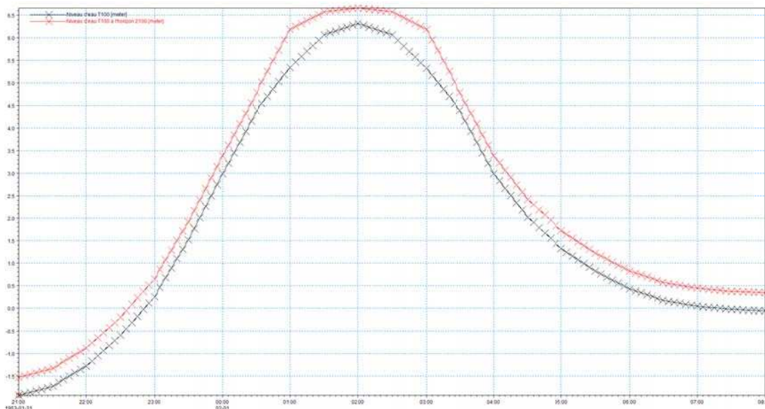
Figure 8-236 : Marégrammes utilisés au large d'Audresselles pour T100 et T100 à l'horizon 2100
