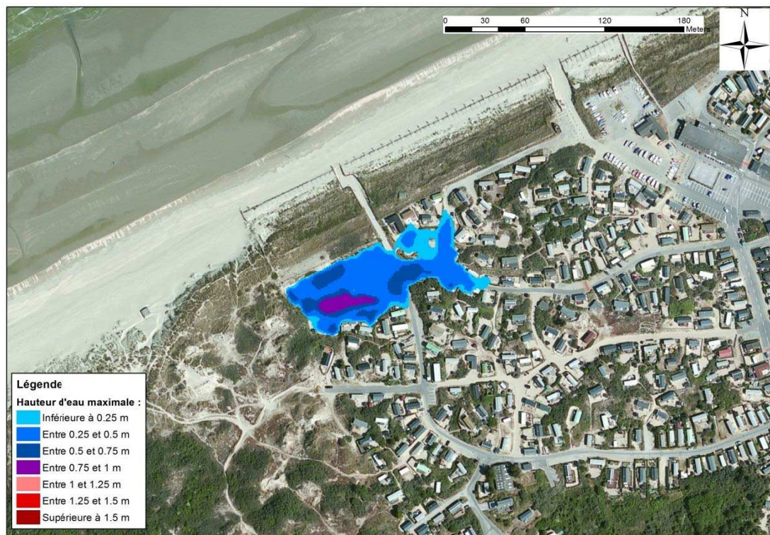
Figure 8-3 : Bray-Dunes, rupture cordon dunaire - Cartographie de la hauteur de submersion modélisée pour un événement décennal
