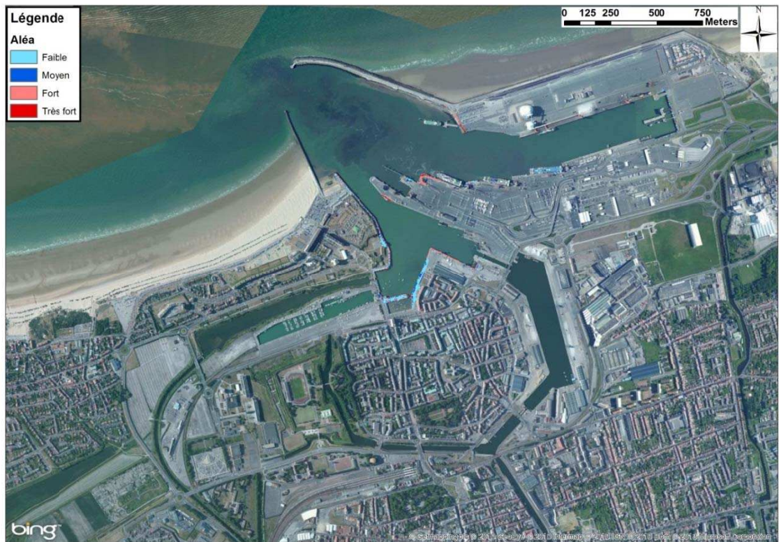
Figure 8-139 : Calais - Cartographie de l'aléa submersion modélisé pour un événement centennal
