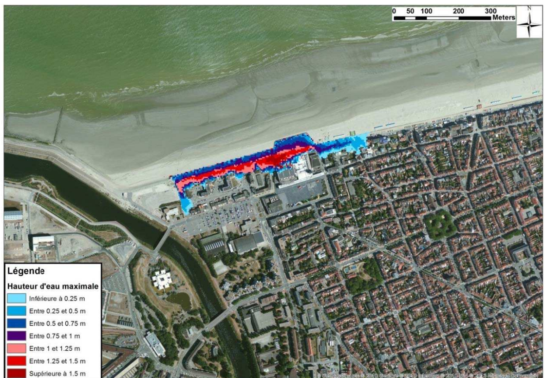
Figure 8-44 : Malo les Bains - Cartographie de la hauteur de submersion modélisée pour un événement centennal à l'horizon 2100
