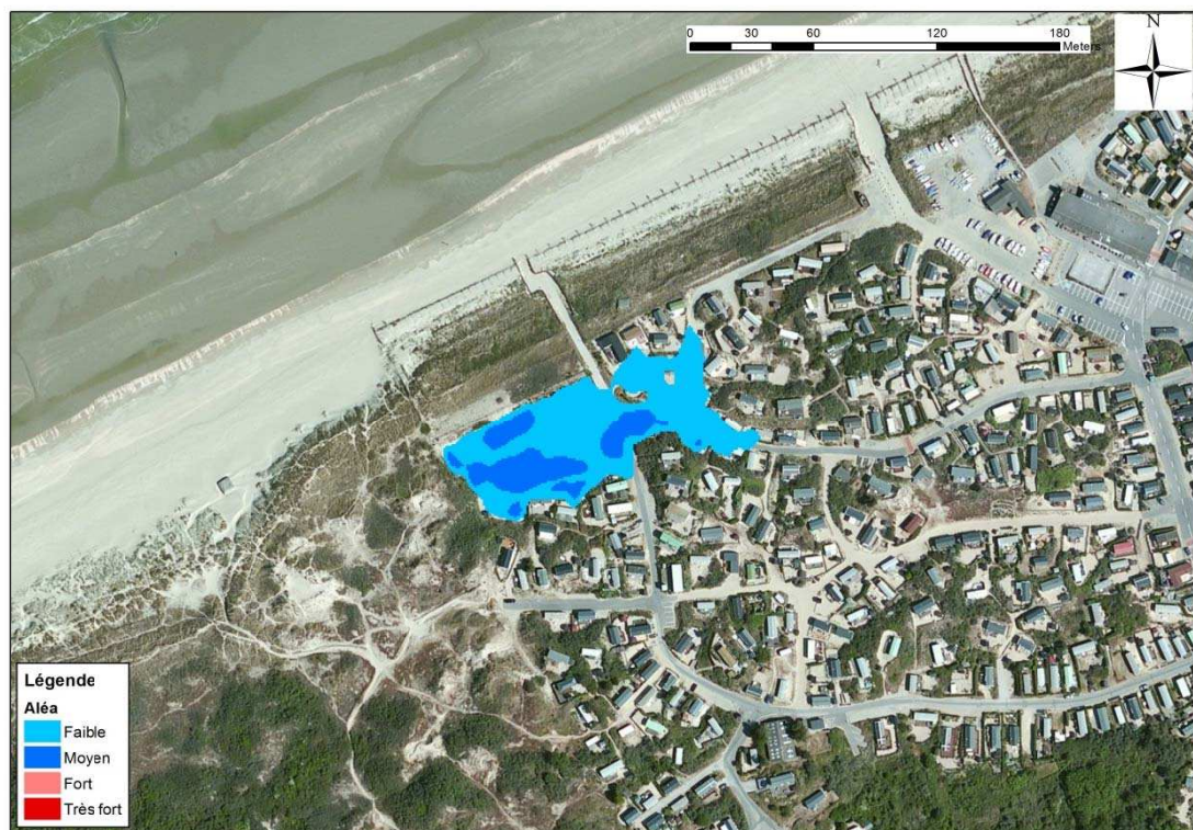
Figure 8-4 : Bray-Dunes, rupture cordon dunaire - Cartographie de l'aléa submersion modélisé pour un événement décennal
