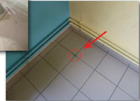
Un trou de 1 à 1.5 cm de diamètre est percé et rebouché après la mesure.
