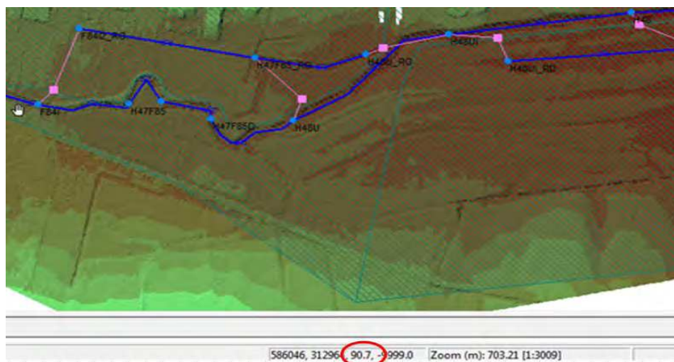
Figure 16 : Le TIN – modèle numérique de terrain
