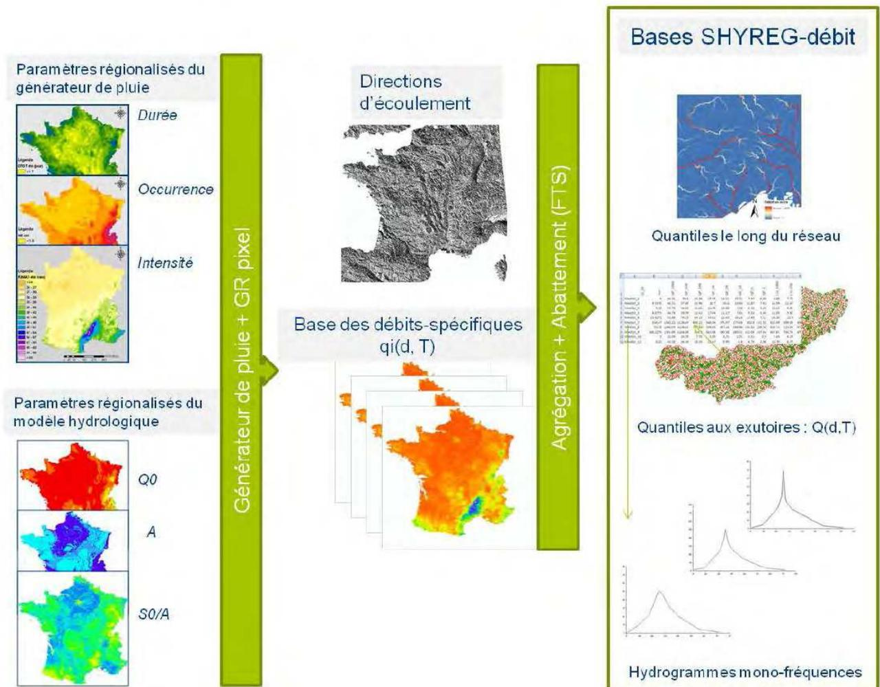
Figure 70 : Principes généraux – Méthode SHYREG
