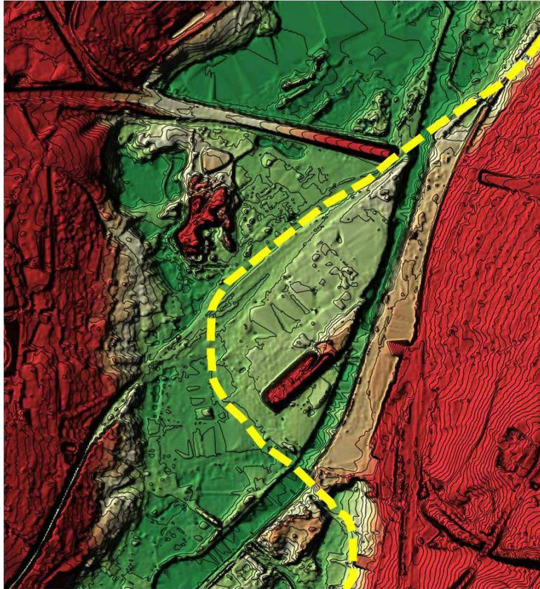
Figure 21 - Correction par analyse de la topographie de la limite du lit majeur dans les secteurs de discordance
