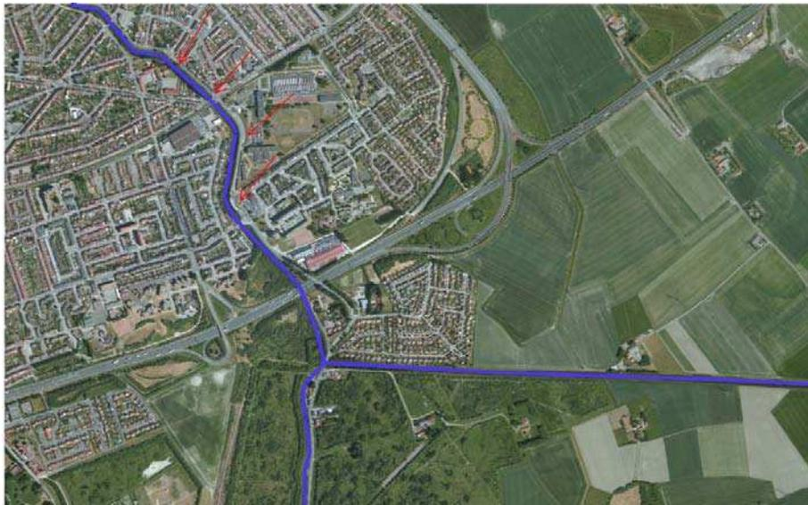
*Schéma explicatif de la restitution d'eau dans le canal des Moeres entraînant une modification du débit dans le canal de Coudekerque (affluent du canal des Moeres, au sud)*
