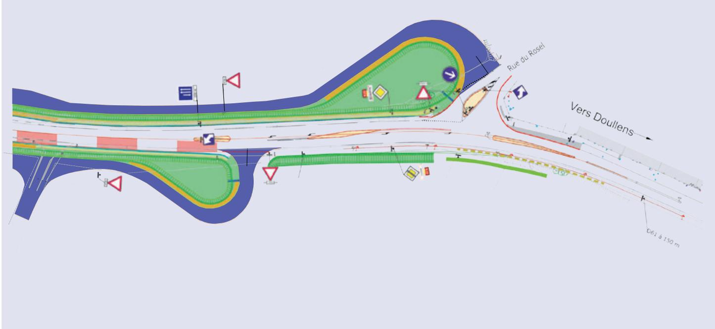
Le carrefour de raccordement de l'entrée sud de Beauval (carrefour entre la RN25 et la rue du Rosel) sera aménagé en tourne-à-gauche avec le raccordement des futures voies agricoles.
