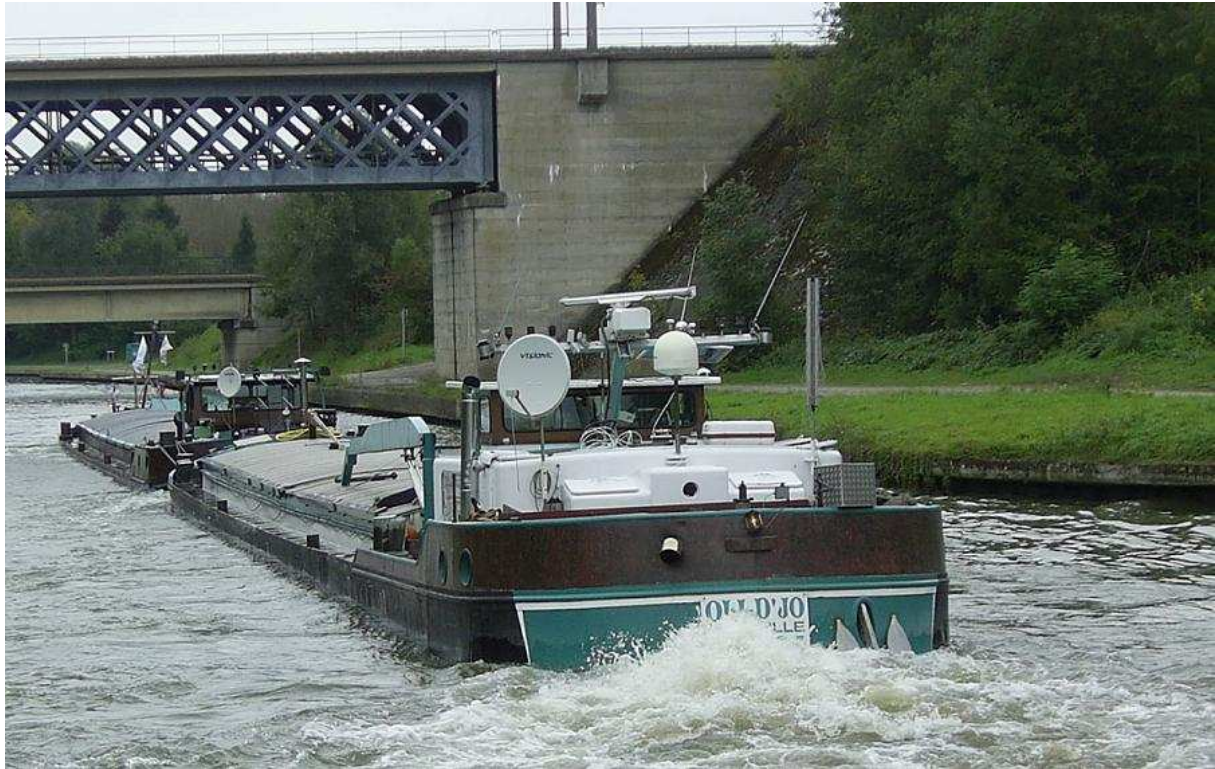
Illustration 13 - Photo CETE Nord Picardie, D. Baudry - convoi Freycinet en flèche - Canal du Nord - 2006
