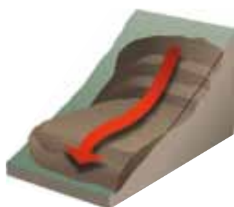
Glissement à surface de rupture circulaire
