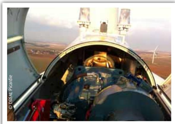
Le rotor d'une éolienne, ouvert lors de l'inspection
