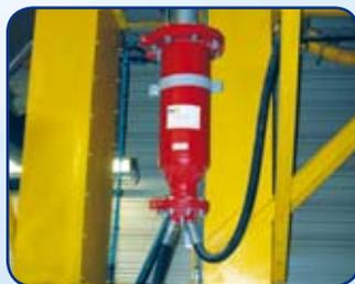
Suppresseurs d'explosion et élévateurs
