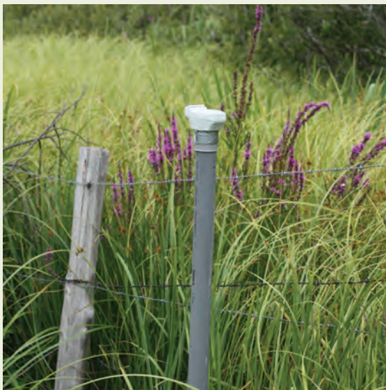
Piézomètre équipé d'une sonde de mesure automatique
