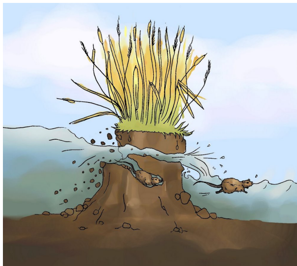
Figure 83: Illustration de l'impact des Rats musqués sur les digues - Source : Marine Casetta, 2019.
