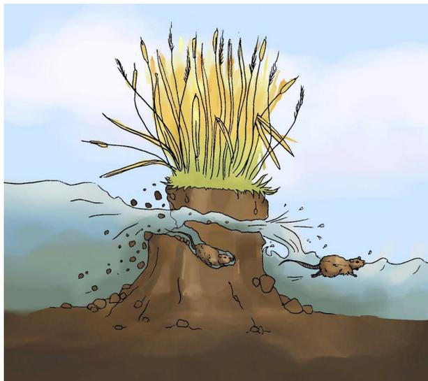
Figure 13 : Illustration de l'impact des Rats musqués sur les digues - Source : Marine Casetta, 2019.
