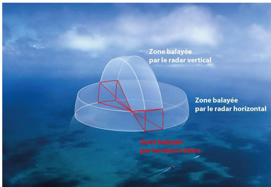
**Figure 3.** Représentation schématique des volumes de détection de deux radars (le radar horizontal a une portée de 12 km, non représentée ici)
