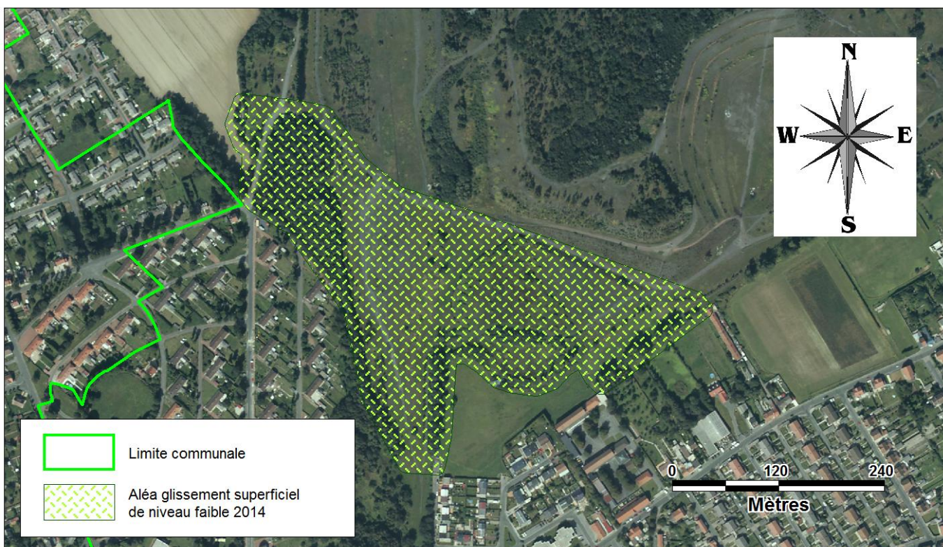
Figure 32 : Nouvelle cartographie (2014) de l'aléa glissement superficiel de niveau faible sur le terril 260
