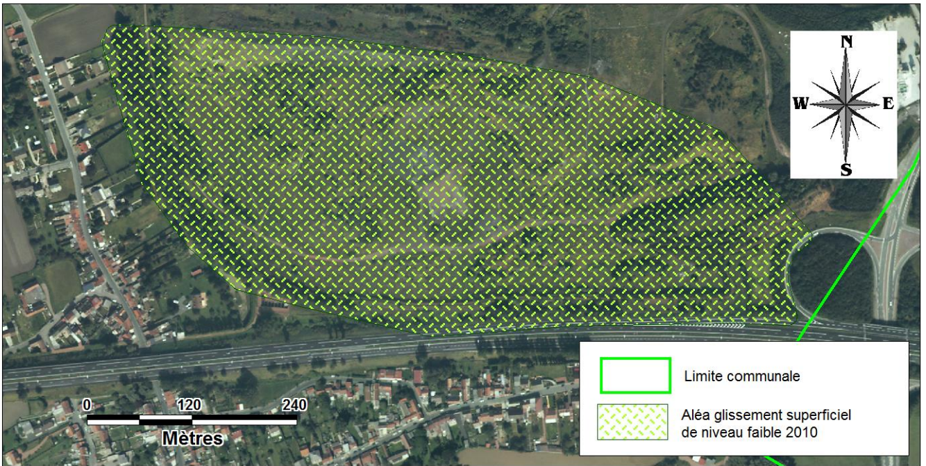
Figure 9 : Ancienne cartographie (2010) de l'aléa glissement superficiel de niveau faible sur le terril 83
