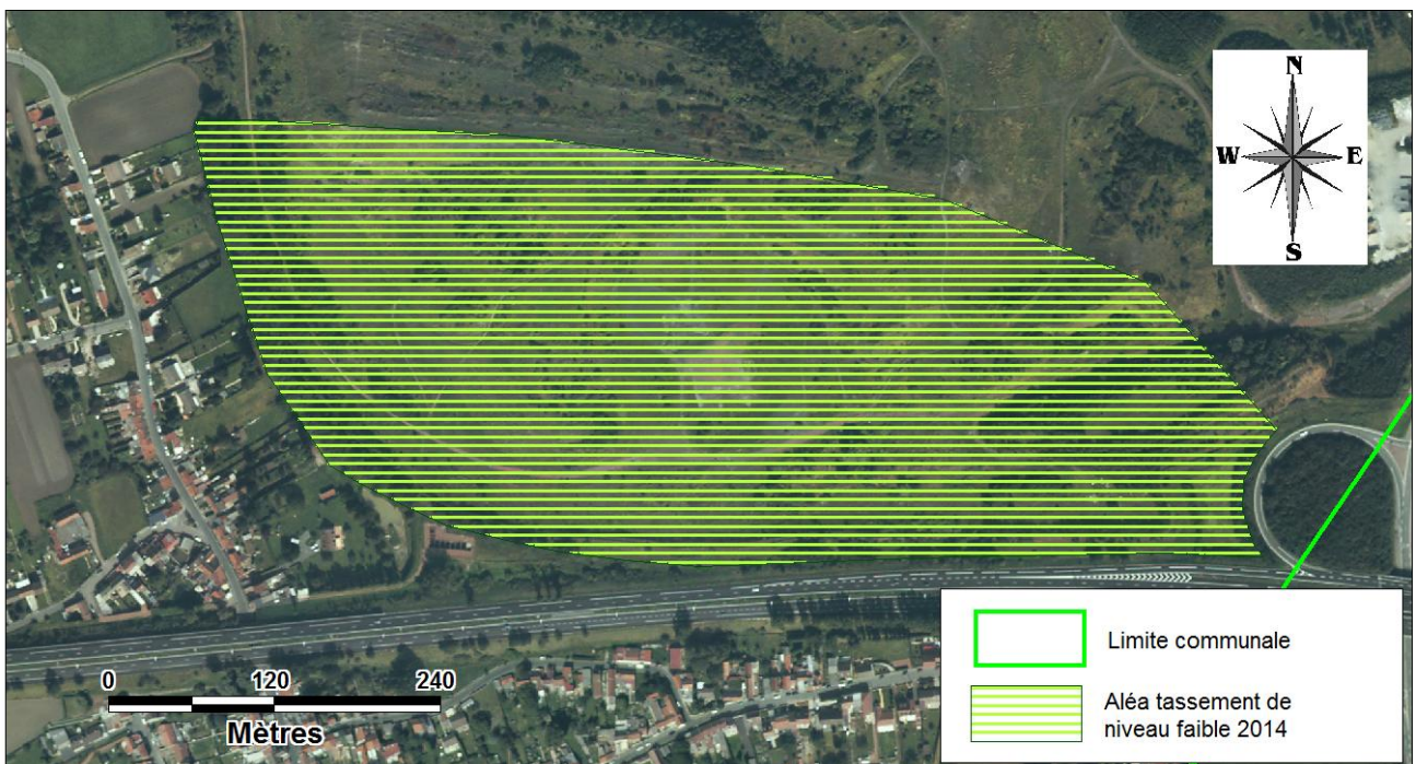
Figure 8 : Nouvelle cartographie (2014) de l'aléa tassement de niveau faible sur le terriil 83
