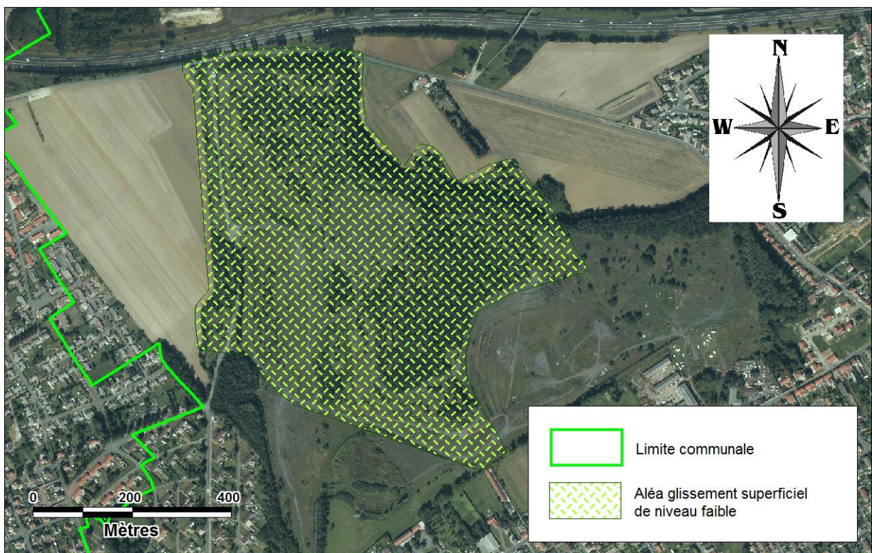
Figure 40 : Cartographie 2014 de l'aléa glissement superficiel de niveau faible sur le terri 95A et les bassins 9, 12 et 13
