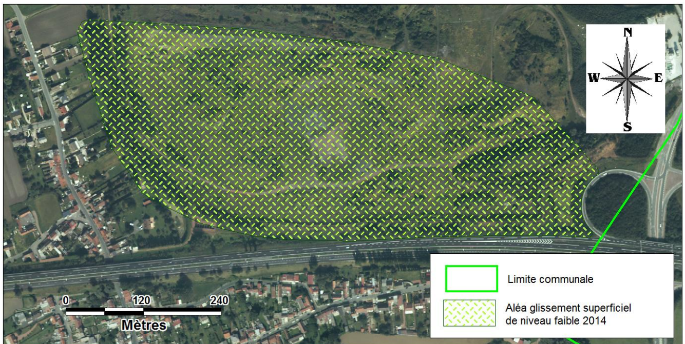
Figure 10 : Nouvelle cartographie (2014) de l'aléa glissement superficiel de niveau faible sur le terril 83
