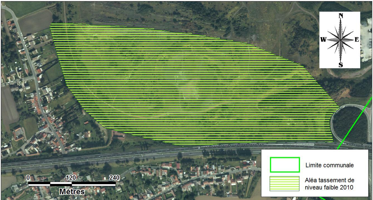
Figure 7 : Ancienne cartographie (2010) de l'aléa tassement de niveau faible sur le terriil 83
