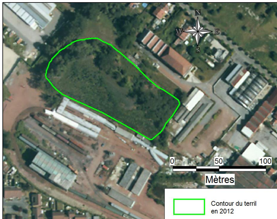
Figure 4 : Contour du terril en 2012 - pris au GPS différentiel
