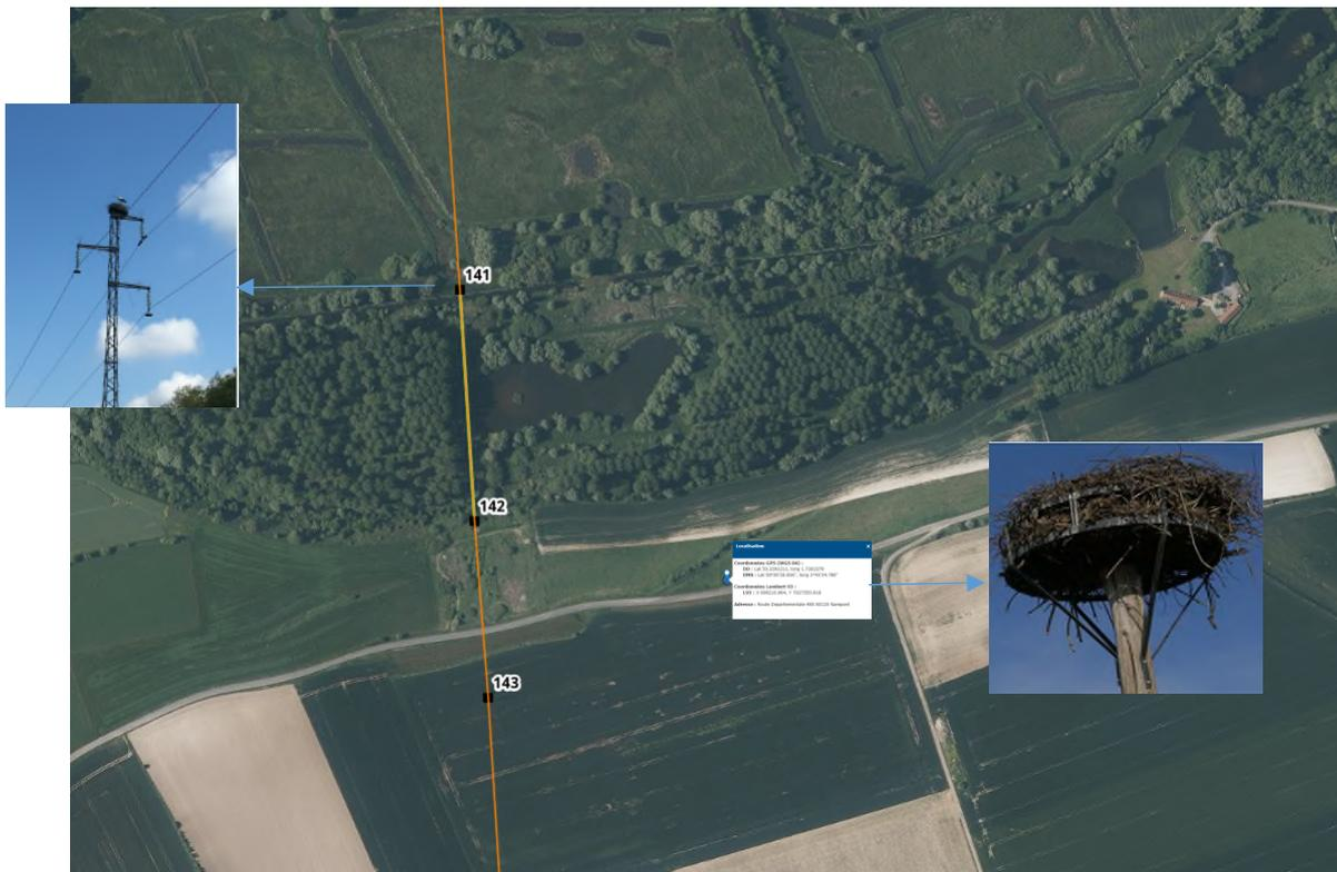
Dans l'immédiat, un nid situé sur la ligne à 90 000 volts Caudière-Sorrus nécessite d'être enlevé car construit à un endroit dangereux pour les individus. Le pylône ne pouvant accueillir une plateforme, un mât sera installé au plus proche (cf ci-dessus). Une convention tripartite entre RTE, le propriétaire du terrain (et du mât) et l'expert avifaune en charge du suivi de la mesure est signée afin d'en garantir la pérennité (cf convention en annexe).
