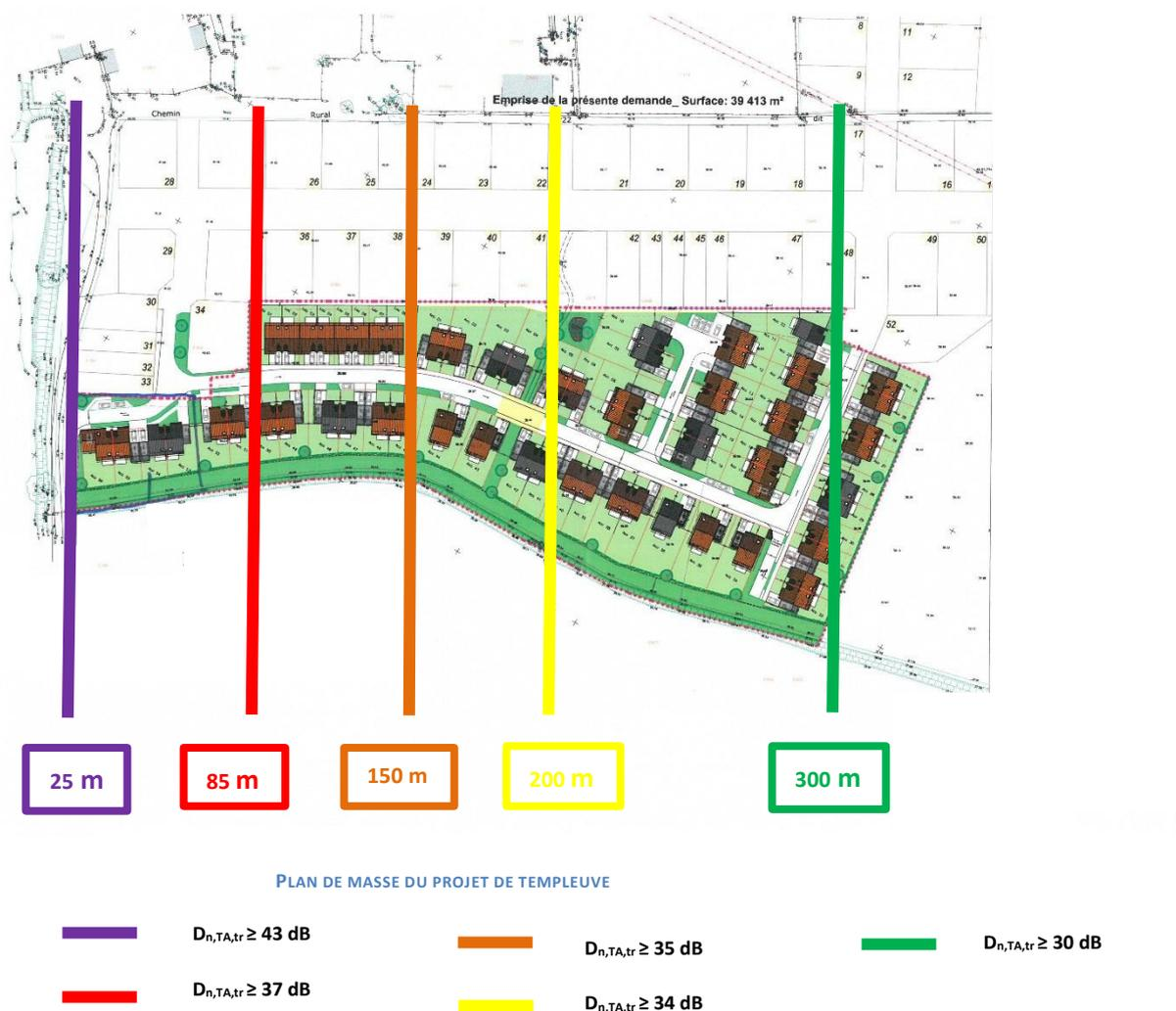
L'ensemble de ces délimitations permet d'avoir une image géographique de l'impact acoustique de la voie ferrée sur le projet. A noter qu'il faudra prévoir un  $D_{n,TA,tr}$  **compris entre 37 et 43 dB** pour les logements individuels situés au plus proches de la voie ferrée.
