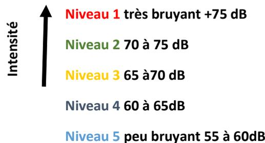
Le classement aboutit à la détermination du secteur de part et d'autre de la voirie, où une isolation acoustique renforcée des bâtiments est nécessaire.
