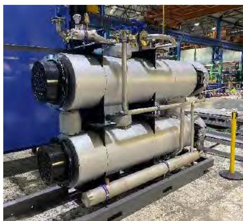
Les gaz de fumée du four pyrolytique entrent dans le refroidisseur de gaz de combustion et sont refroidis à la plage de température de fonctionnement du filtre de 120°C à 150°C. La chaleur retirée des gaz de fumée est transférée par un système de circulation d'eau / éthylène glycol à un refroidisseur d'air (aérotherme) dédié situé à l'extérieur de l'équipement de filtration.
