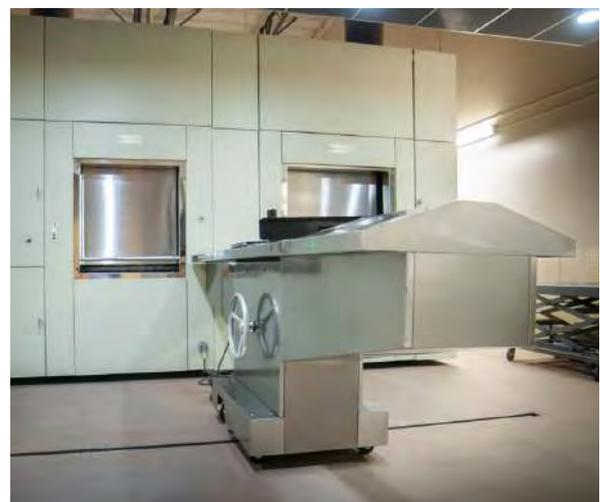
entièrement capotée avec des panneaux en inox garnis de plaques anti-bruit. Le système de poussée est fourni avec 3 têtes, de différentes longueurs de manière à ce que les cercueils soient toujours placés de la même façon dans le four. Une
