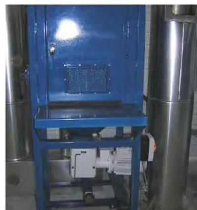
Le neutralisant « Factivate » est fourni dans des conteneurs fermés – en standard – de 20 l (15 kg) faciles à gérer, aisément introduits dans la station dédiée.
