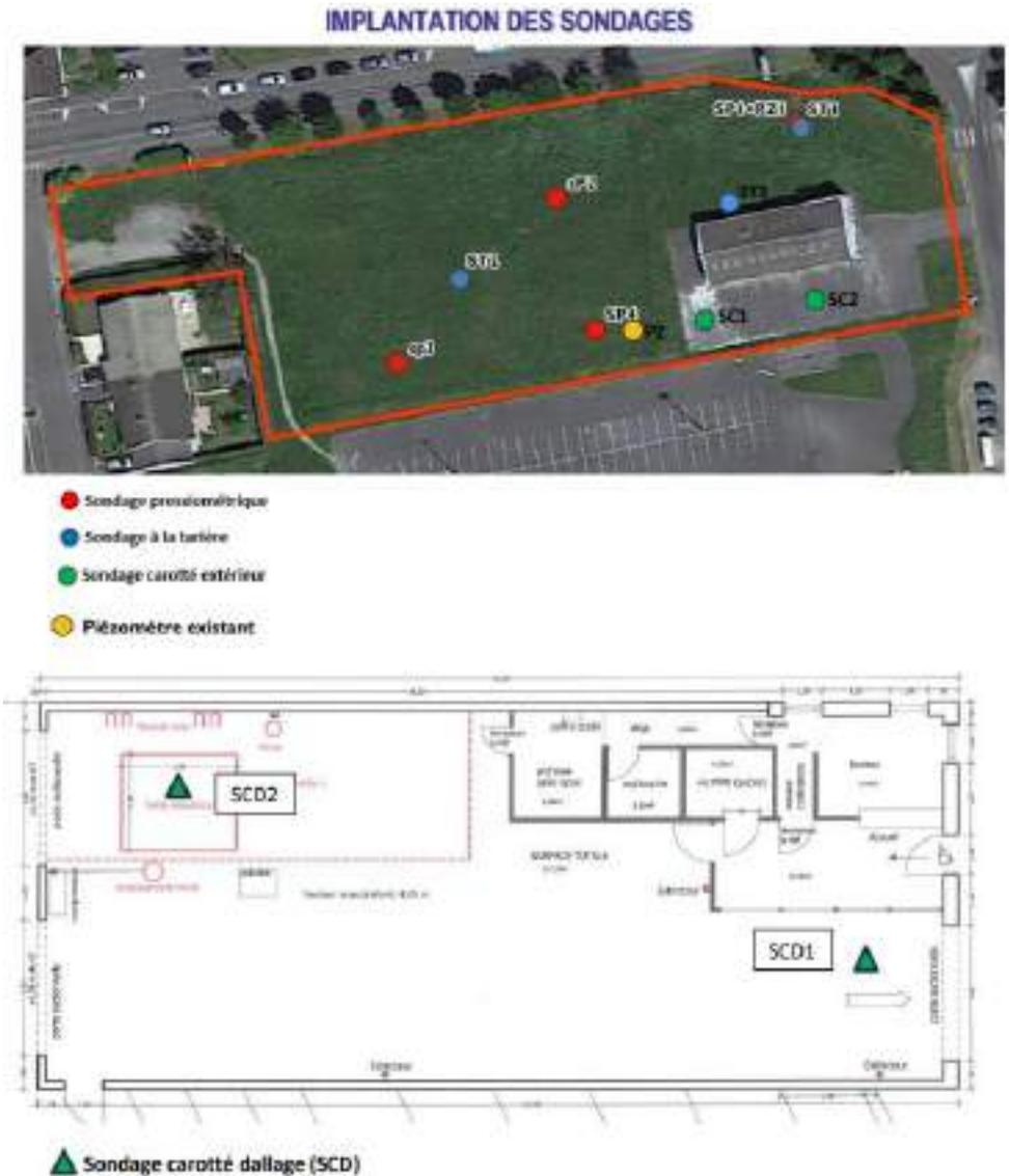
Figure 6 : Implantation des sondages géotechniques – Source : ISROG géotechnique
