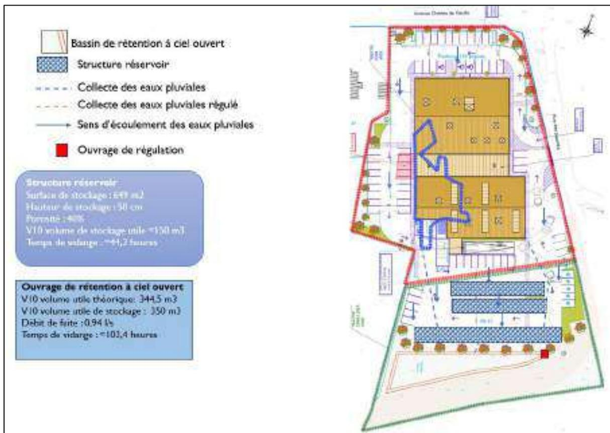
Figure 10 : Schéma de principe de gestion totale des eaux pluviales au droit du projet (plan complet voir annexe I)
