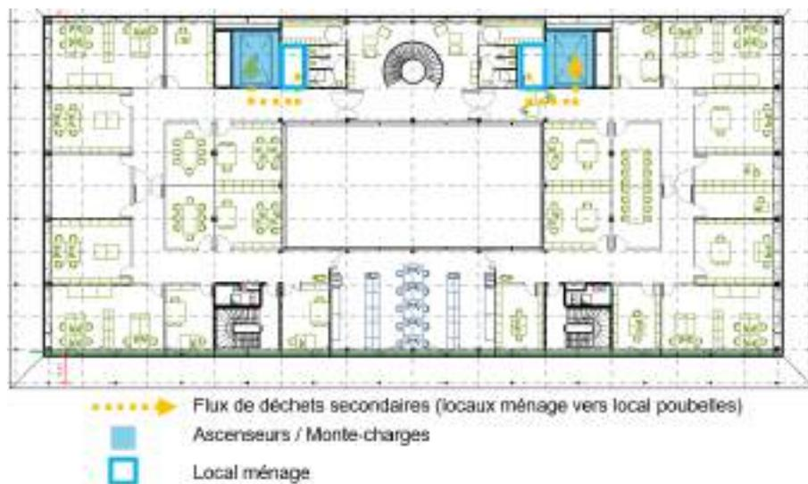
Figure 14 – Plan de repérage des locaux et flux déchets au R+1
