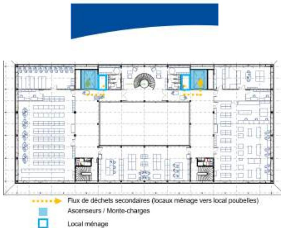
Figure 16 – Plan de repérage des locaux et flux déchets au R+3
