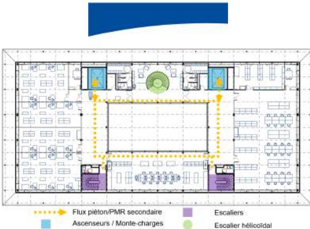
Figure 21 – Plan de repérage de l'accessibilité intérieure des travailleurs au R+2
