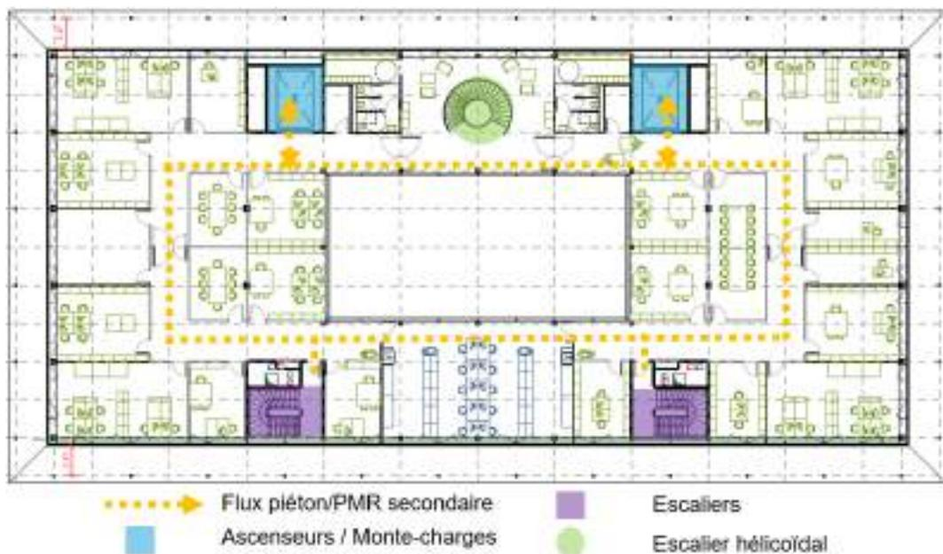
Figure 20 – Plan de repérage de l'accessibilité intérieure des travailleurs au R+1
