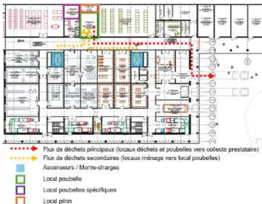
Figure 12 – Plan de repérage des locaux et flux déchets au RDC Bas
