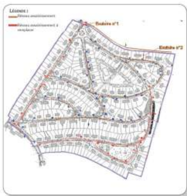
Figure 24 : Localisation des exutoires— Source : © Urbycom
