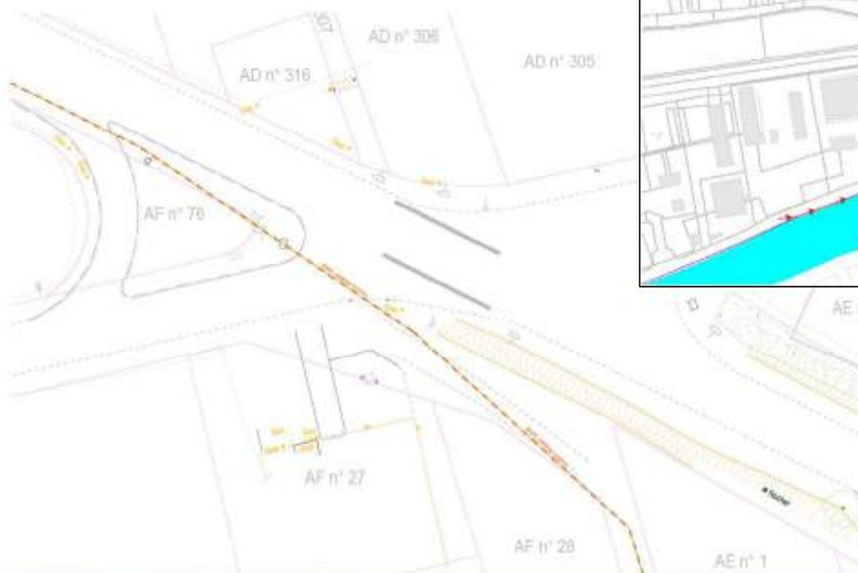
Absence de réseau d'eaux pluviales dans la zone d'étude. Les écoulements des eaux de voirie se font sur les accotements engazonnés et les champs. Quelques parties de voiries sont bordurées (en bleu), elles sont uniquement interrompues pour permettre l'écoulement des eaux dans les champs.
