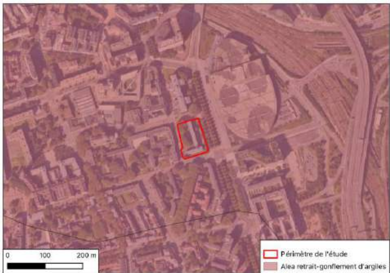
Illustration 17 : Cartographie de l'aléa retrait-gonflement des argiles au droit du projet – Source Géorisques
