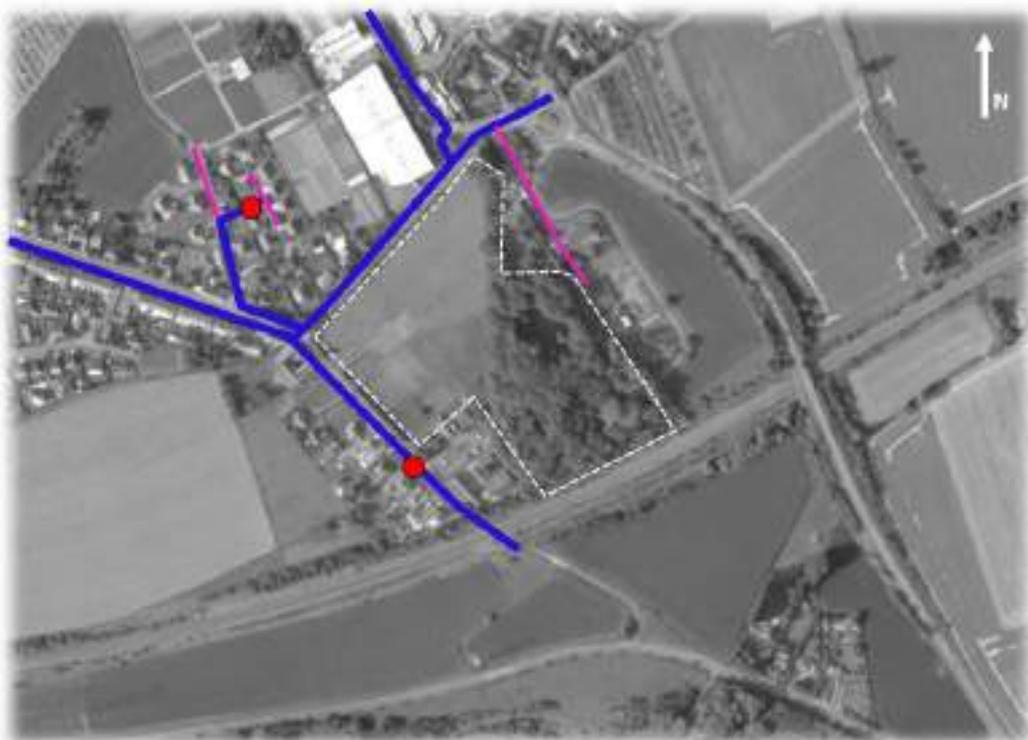
Figure 9 : Localisation des Réseaux d'Adduction d'Eau Potable et de Défense Incendie
