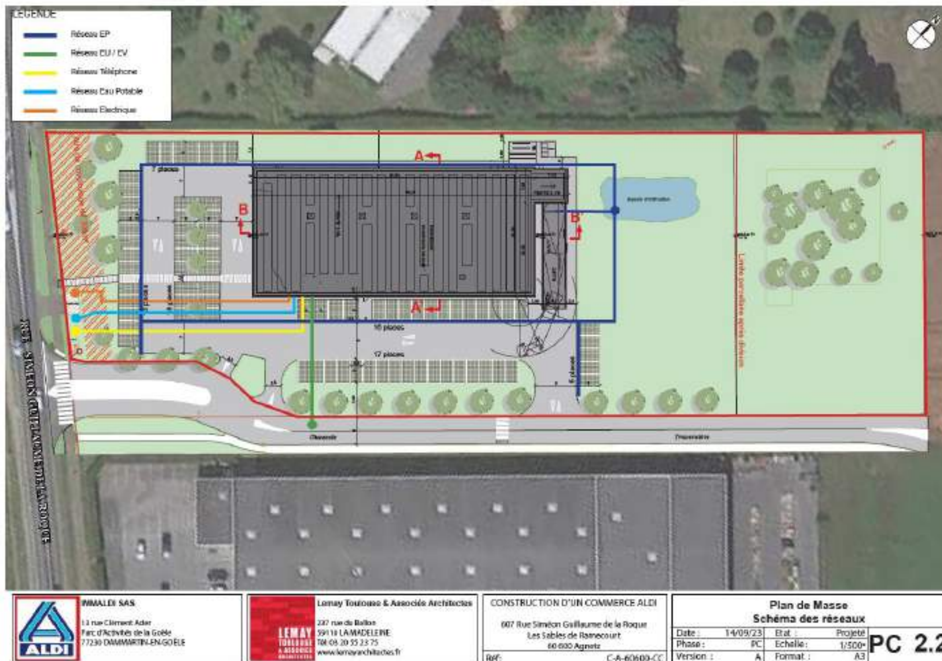
Figure 29 : Plan masse des réseaux – Source : Aldi – LEMAY
