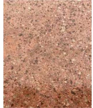
Béton coloré dans la masse avec finition poncée (sec / mouillé)
