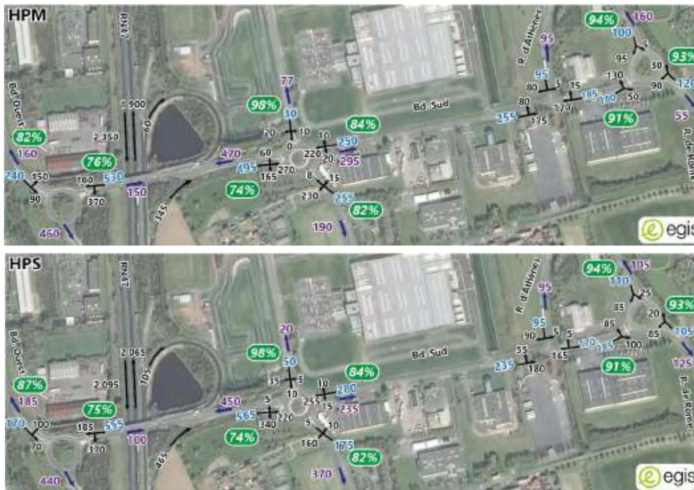
FIGURE 22 : FONCTIONNEMENT DES GIRATOIRES DU BD. SUD (SOURCE : ALYCE, TRAITEMENT : EGIS)
