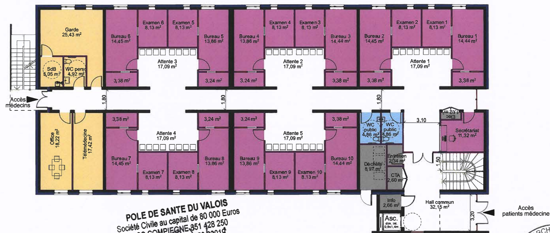
RdC : Médecine générale
