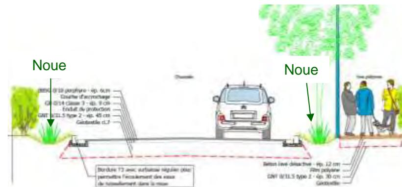
Figure 26 : Coupe de principe de la voirie du projet (source : EVIA).
