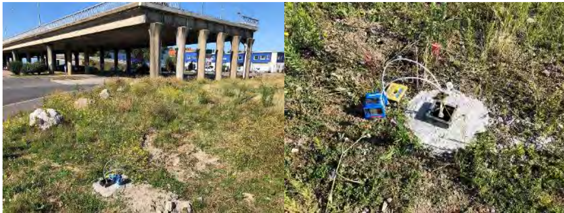
Figure 5.1 Prélèvements en cours au niveau des piézaires du site
