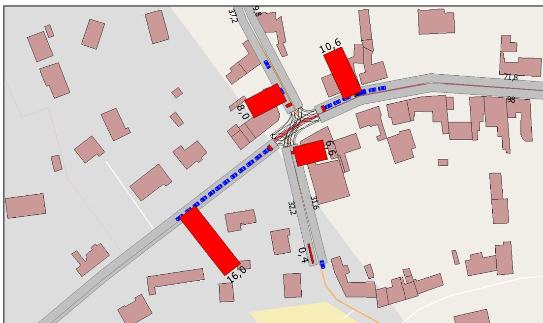
**Document n° 44** : Résultats de la simulation à l'état en 2029, avec le projet et allongement du feu vert de la RD940 : accumulation de véhicules au carrefour à feux des RD940/RD219, à l'HPS.
