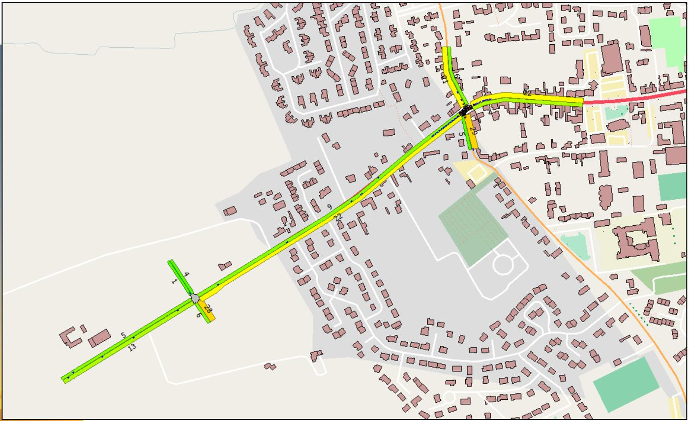
**Document n° 46** : Résultats de la simulation à l'état en 2029, avec le projet et allongement du feu vert de la RD940 – densités de circulation sur les axes principaux à l'HPS.
