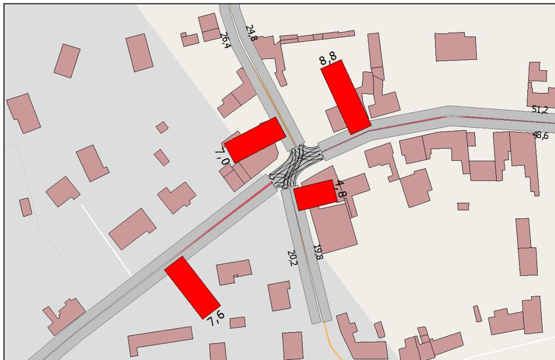
**Document n° 36 :** Résultats de la simulation à l'état actuel : accumulation de véhicules en attente au carrefour à feux, à l'HPS.
