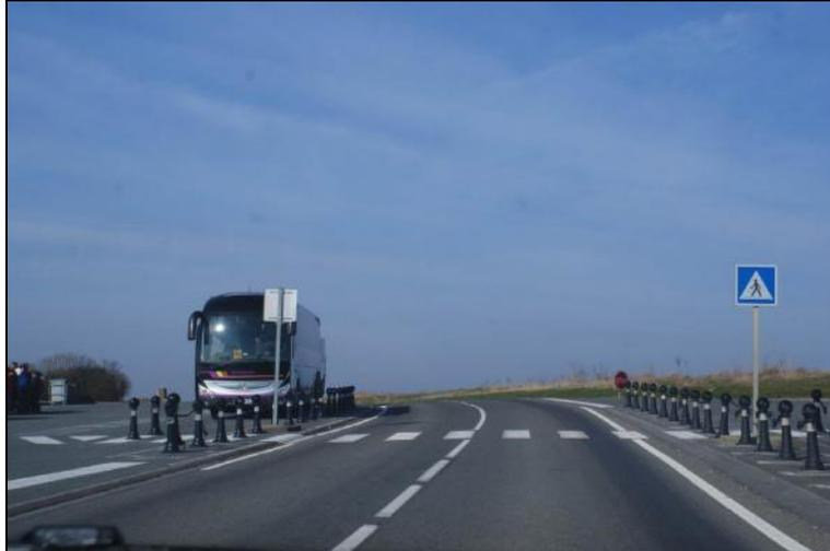
Un panneau C20a est implanté en position du passage piéton, conformément à l'article 72-1 de l'IISR – 5<sup>ème</sup> partie.
