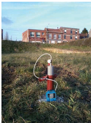
Photographie n°4 : Dispositif de prélèvement des gaz du sol – Pa4 (source : EACM, 03/03/2016)
