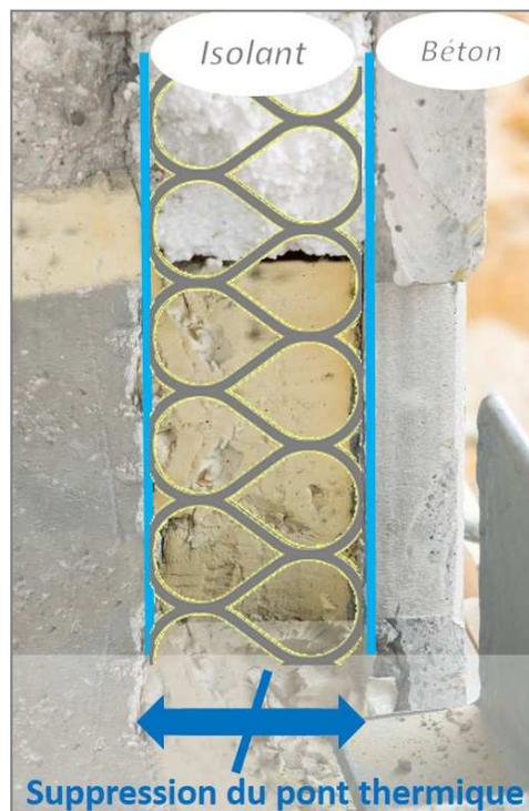
*Une isolation permettant de supprimer les ponts thermiques*
