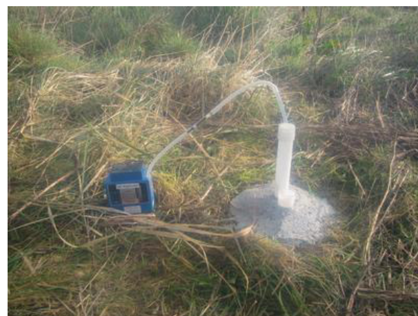
Figure 7 : Implantation d'un piézair et prélèvements des gaz du sol
