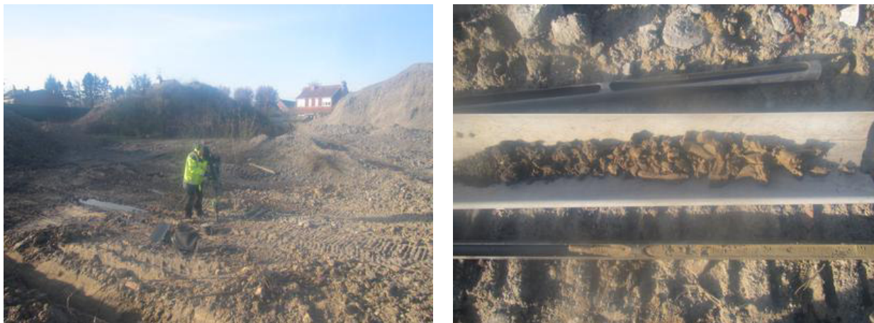
Figure 6 : Technique de forage au carottier portatif
