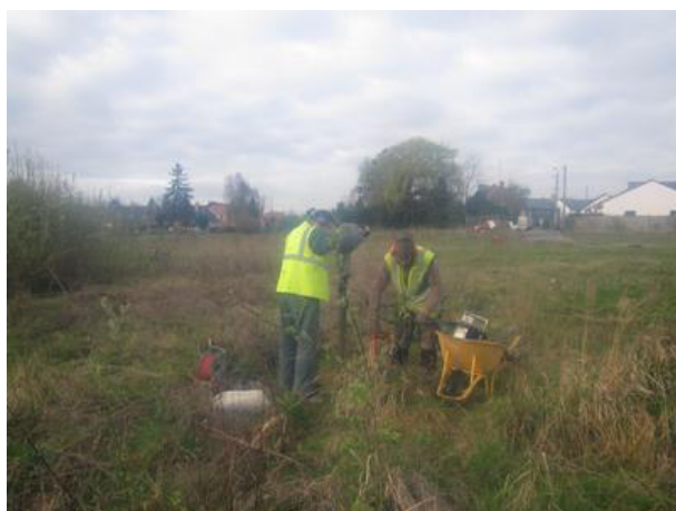
Figure 7 : Implantation d'un piézair et prélèvements des gaz du sol
