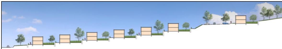
Coupe du projet : Traitement en gradins suivant les courbes de niveaux et limitation des hauteurs à R+1
