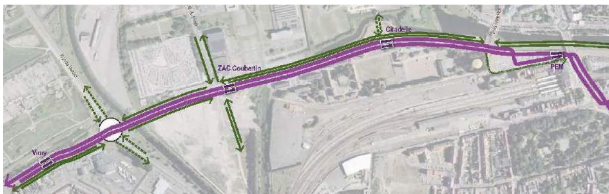
Schéma de fonctionnement cyclable prévu dans le secteur Coubertin : solution bilatérale entre Verdun et 8 mai puis latérale Nord double sens entre 8 Mai et Freycinet
