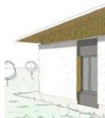
Les toitures seront métalliques et de couleur blanche. Un traitement soigné de la rive au moyen d'un bandeau aluminium permet la réalisation d'un ouvrage fin et uni. Les sous faces des débords reprennent le bois de la « peau intérieure » de la construction. Les eaux de pluies sont canalisées par des gouttières havraises positionnées en rive de toiture.
