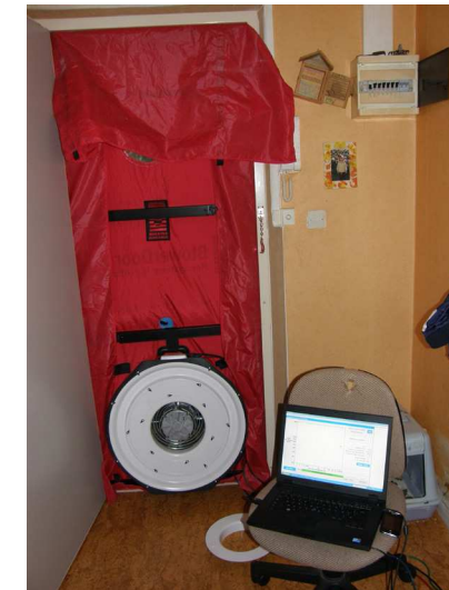
Test de perméabilité à l'air
