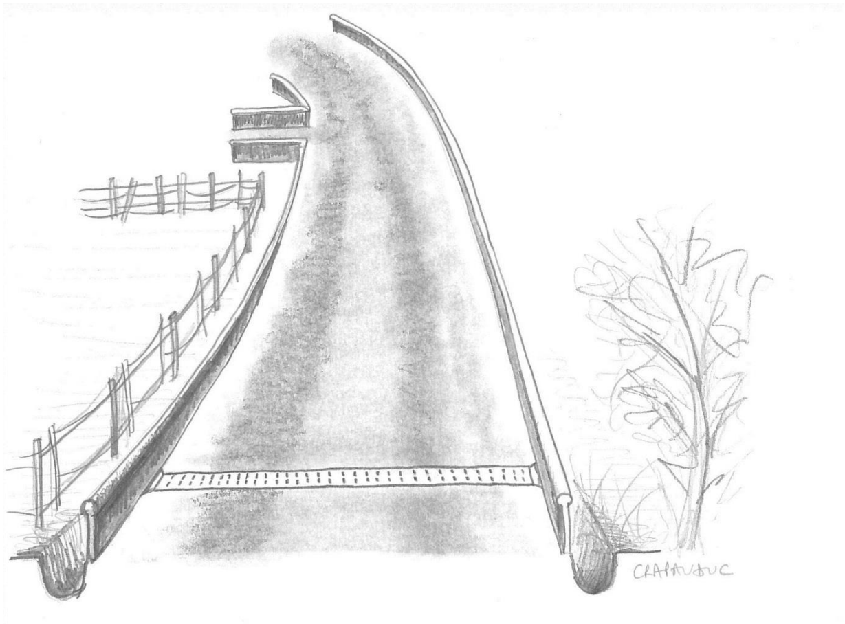
Dessin 1- Tunnel de traversée d'amphibiens
