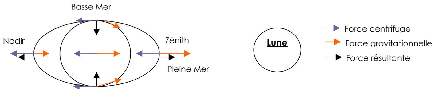
**Figure 5 : Schématisation des forces responsables des pleines et basses mers. En pratique, la lune n'étant généralement pas dans le plan équatorial, le bourrelet situé au nadir est plus faible que celui situé au zénith. Les pleines mers sont alors alternativement faibles et fortes, à l'origine de la composante diurne<sup>4</sup> de la marée. Cette composante peut être négligeable, comme sur la façade atlantique.**
