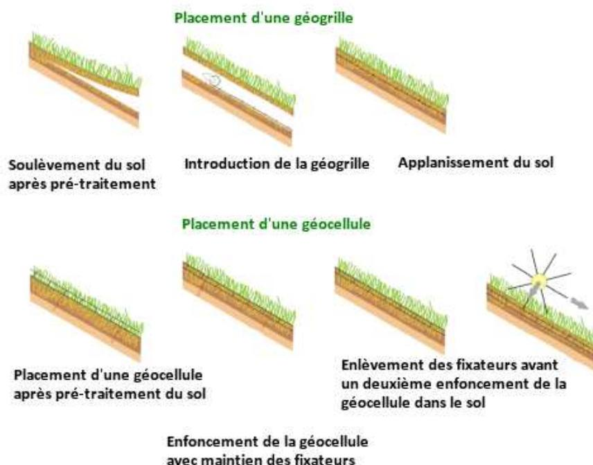
**Figure 27 : Placement des géocellules et des géogrilles, d'après le site Internet COMCOAST, 2005**
