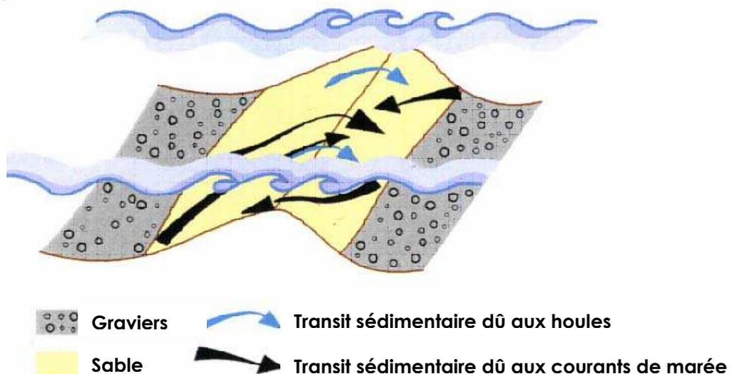
Figure 9 : Transits sédimentaires au large, source Plan Littoral d'Actions pour la Gestion de l'Erosion (PLAGE), 2003.
