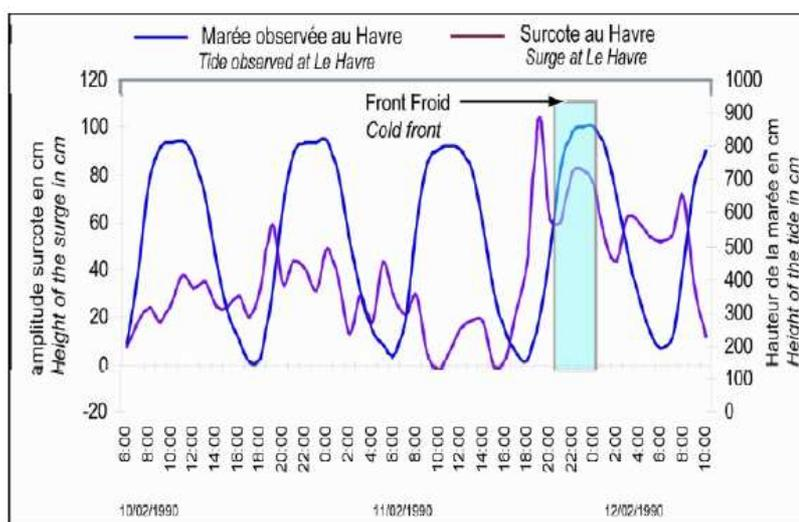
Figure 22 : Exemple de submersion sévère du 12 février 1990 au Havre dans laquelle les facteurs n'étaient pas à leur optimum, source rapport scientifique BAR final, février 2005.
