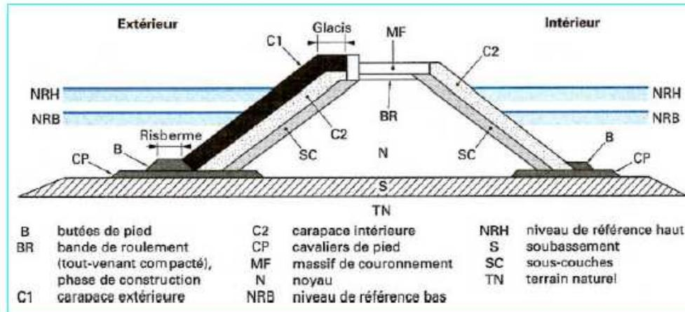
Figure 23 : Éléments constitutifs d'une digue à talus, source article des Techniques de l'Ingénieur intitulé *Ouvrages de protection contre la houle*
