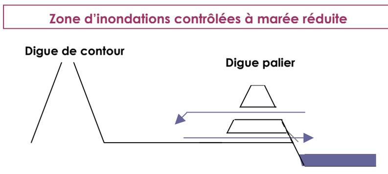
**Figure 111:** Principe d'une zone d'inondations contrôlées avec création d'une zone écologique. A marée montante, l'eau se répand dans la zone d'inondations contrôlées. A marée descendante, l'eau repart vers la mer.
