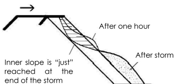
**Figure 31 : Erosion de la couche de sable**
