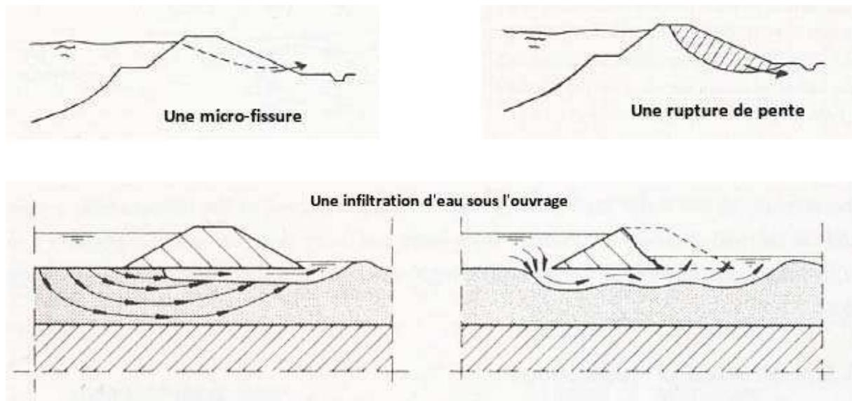
Figure 25 : Principaux mécanismes de dégradation de l'aval d'une digue, source site Internet COMCOAST
