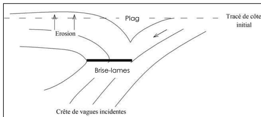
Figure 18 : Inconvénients liés à l'implantation d'un brise-lame aux abords d'une plage source mémoire de Benoît Suret, 2006
