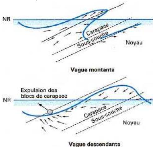
Figure 24 : Action de la houle sur une digue à talus, source article des Techniques de l'Ingénieur intitulé *Ouvrages de protection contre la houle*.
